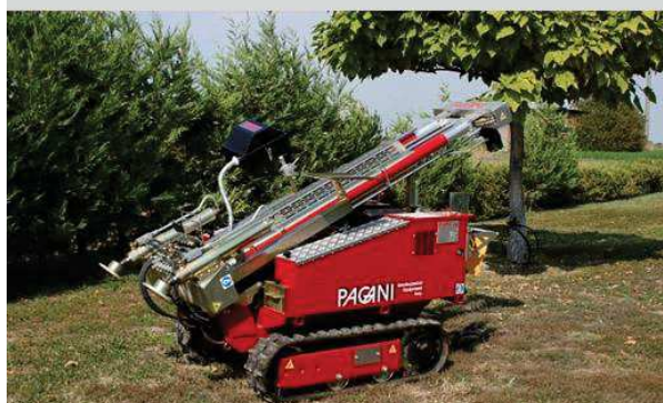
Figura 17 – Penetrometrica dinamico superpesante e statico da 20 ton
