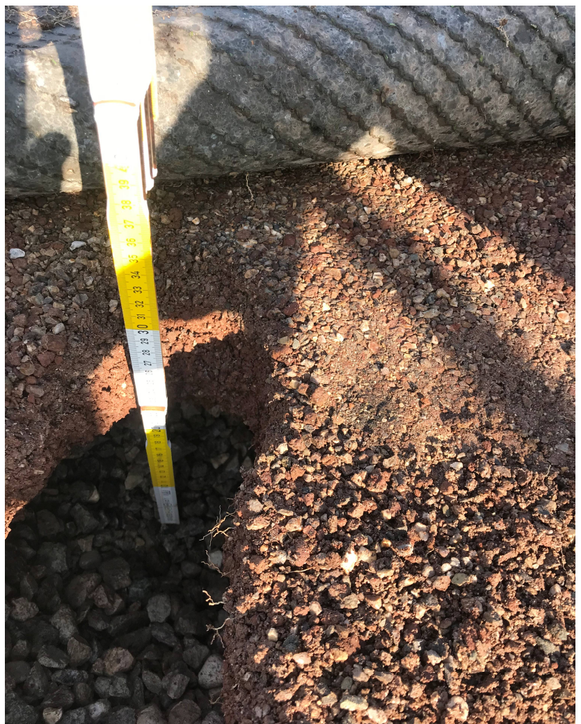
Dettaglio della stratigrafia del campo
