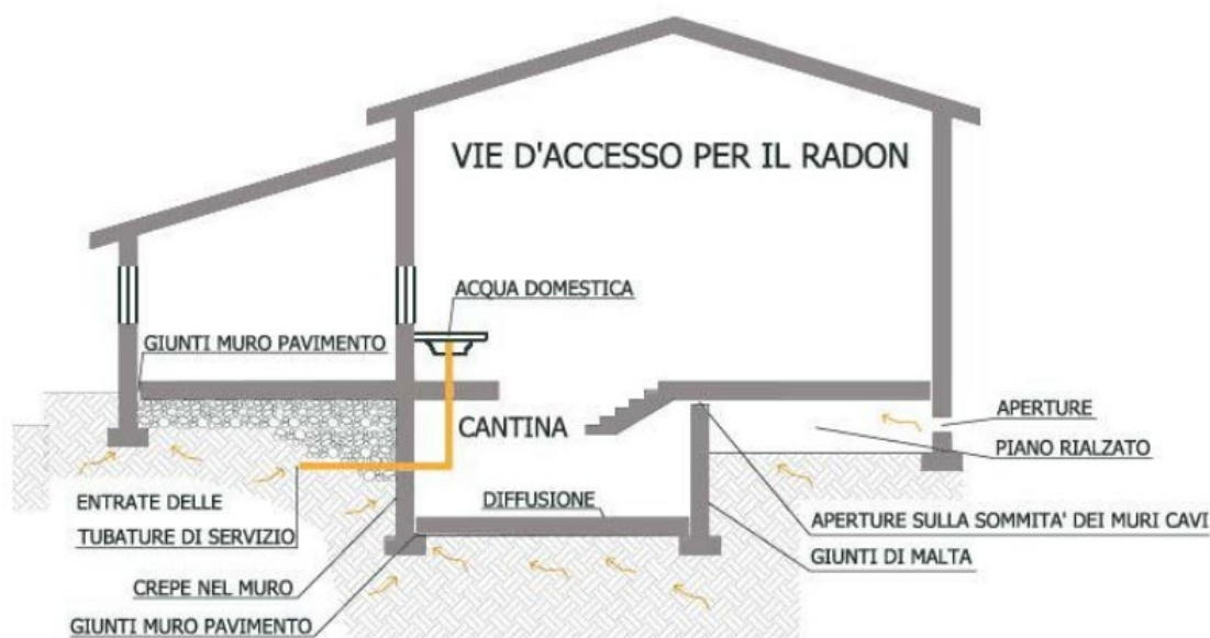
figura 41 schema sulle vie d' accesso del radon nelle abitazioni
