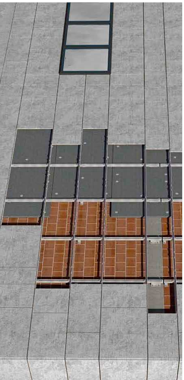
Particolare montaggio e stratificazione di una facciata ventilata
