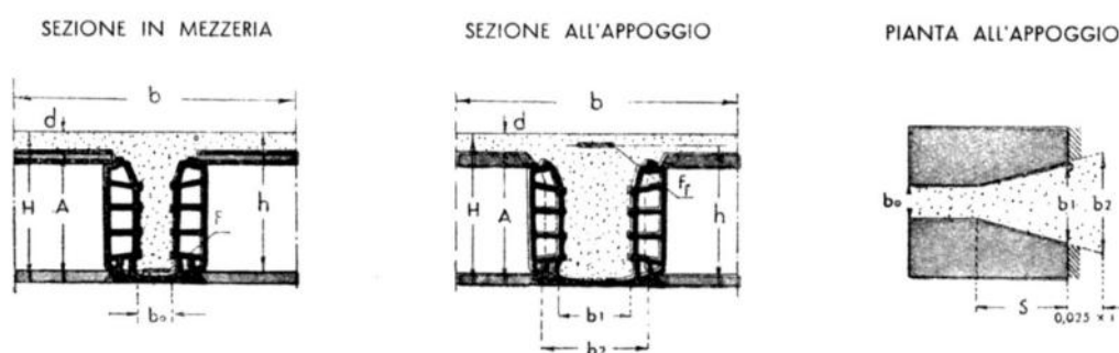
Solaio "Frazzi Bi-Delta" utilizzato nei solai del 1935
