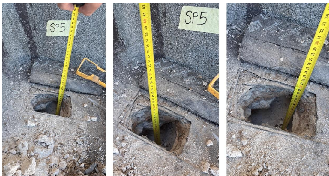
Saggio SP05 : solaio di copertura piano primo
