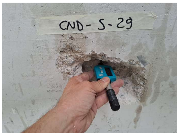
Prove con durometro su barre d'armatura
