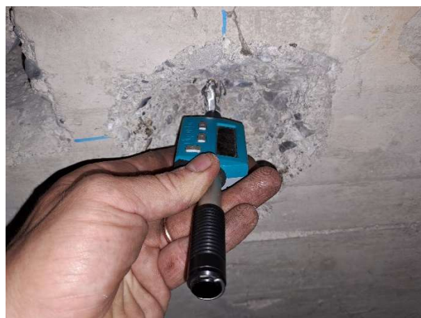
Prove con durometro su barre d'armatura
