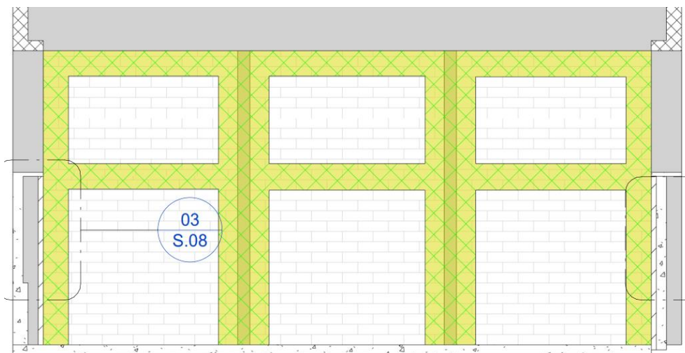
Schema tipologico sistema antiribaltamento tamponature
