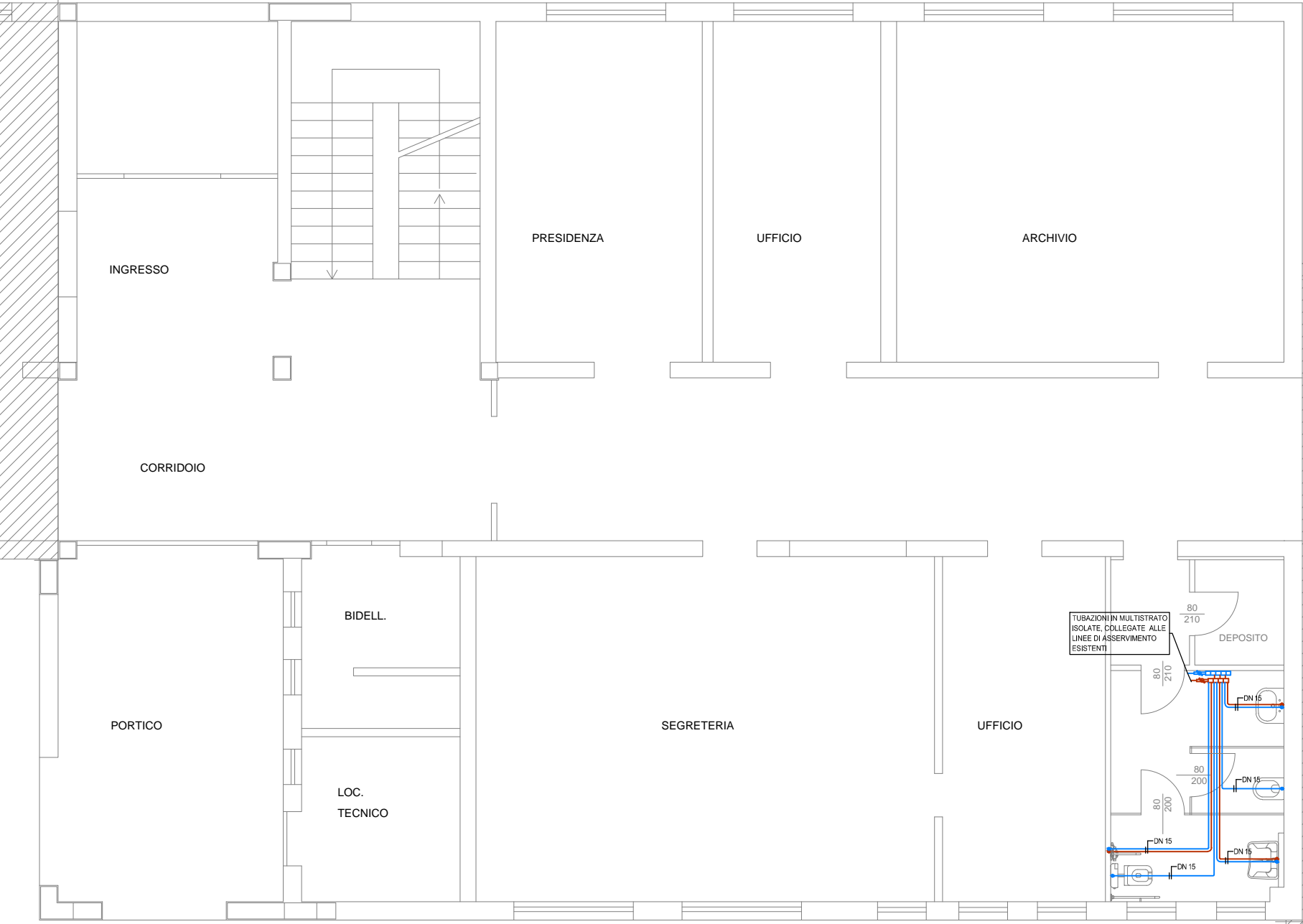
LAY OUT IMPIANTO IDRICO SANITARIO PIANO TERRA SCALA 1:50
