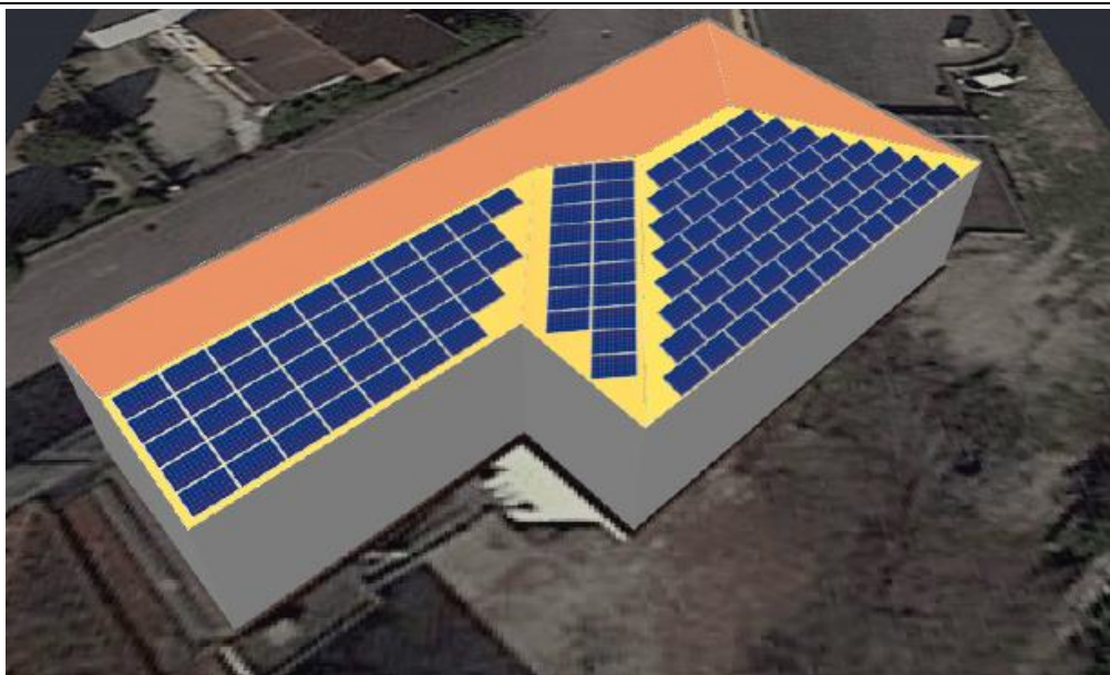
POSIZIONAMENTO PANNELLI IN COPERTURA
