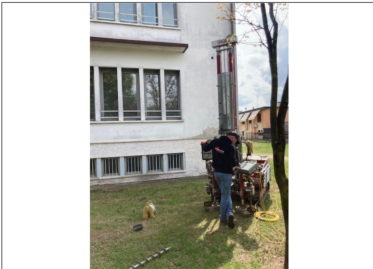
Figura 24 – Documentazione fotografica della prova penetrometrica
