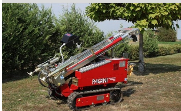
Figura 23 – Penetrometrica dinamico superpesante e statico da 20 ton
