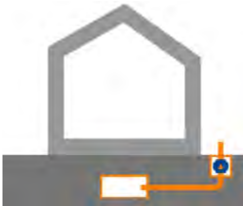
Figure 4: schema evacuazione gas radon in edifici esistenti – DECRETO 12.678 DEL 21.12.2011 R.L.
