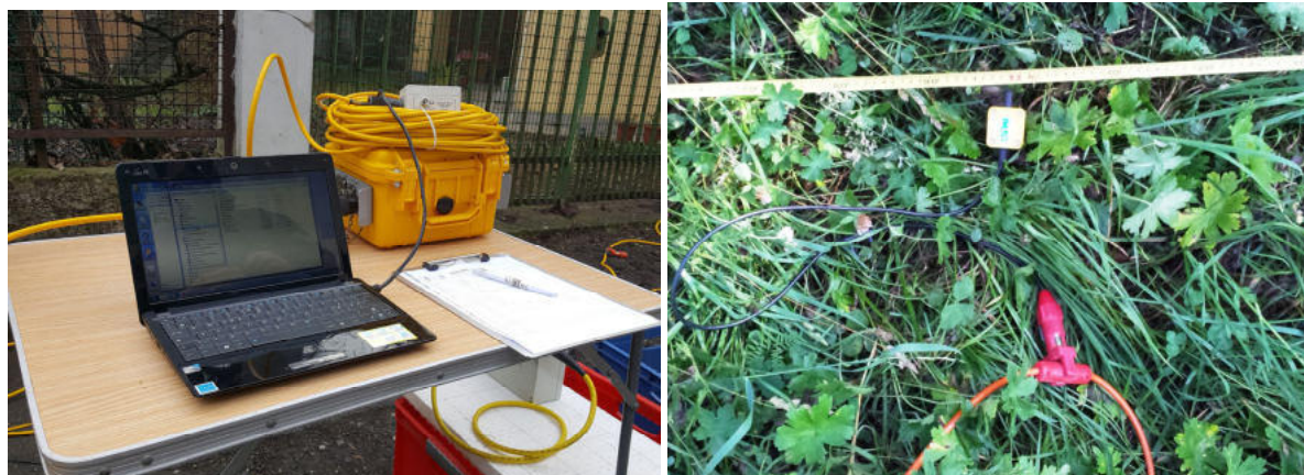
Foto 2 e 3: strumento di registrazione e geofono
