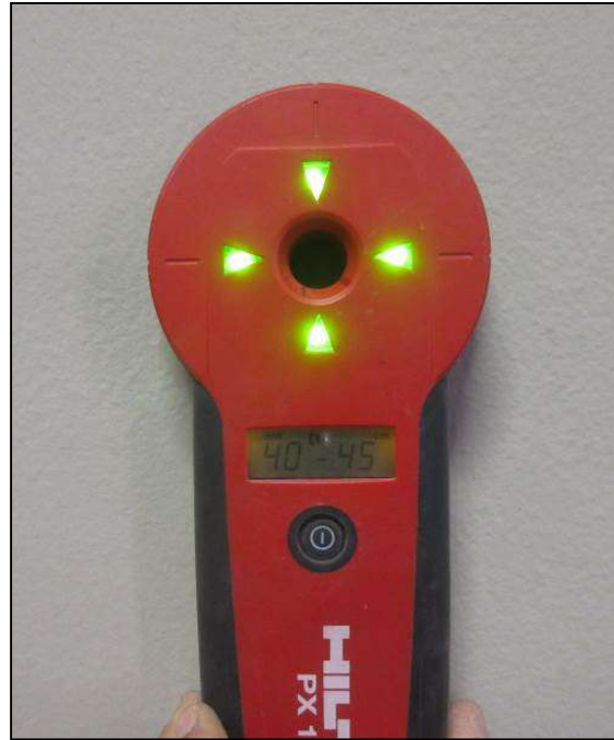
Foto 2 – Misurazione indiretta dello spessore di un setto murario.
