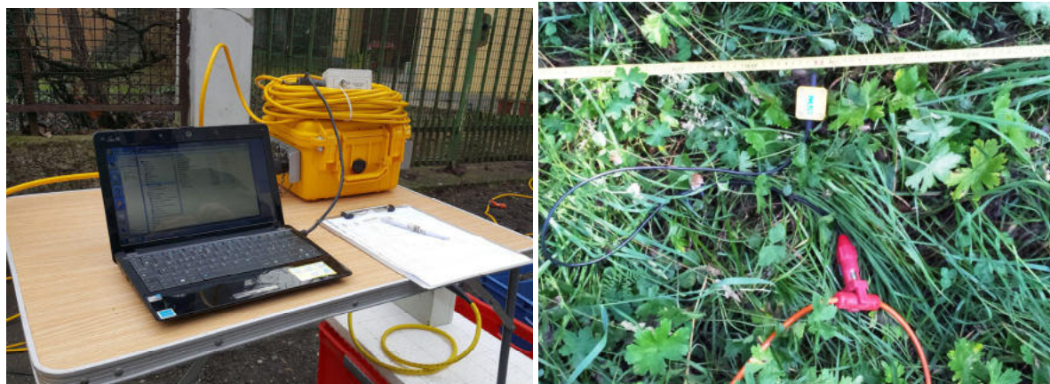
Foto 2 e 3: strumento di registrazione e geofono
