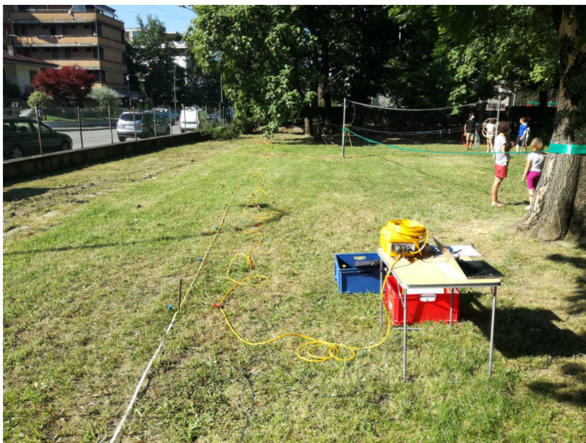
Foto 1: vista dello stendimento MASW effettuato
