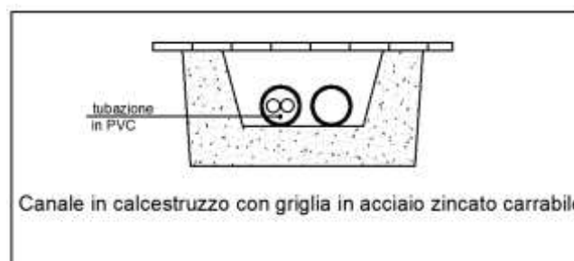
Figura 6 - Dettaglio tubazioni frigorifere interrate in apposito tubo PVC
