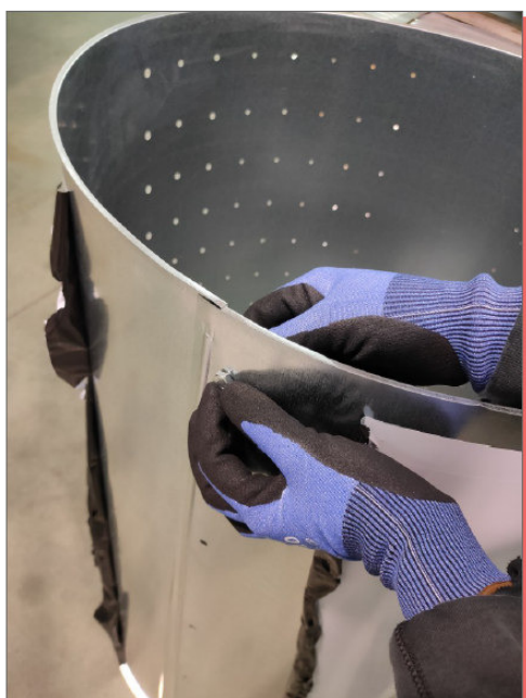
MONTAGGIO DADO E VITE
