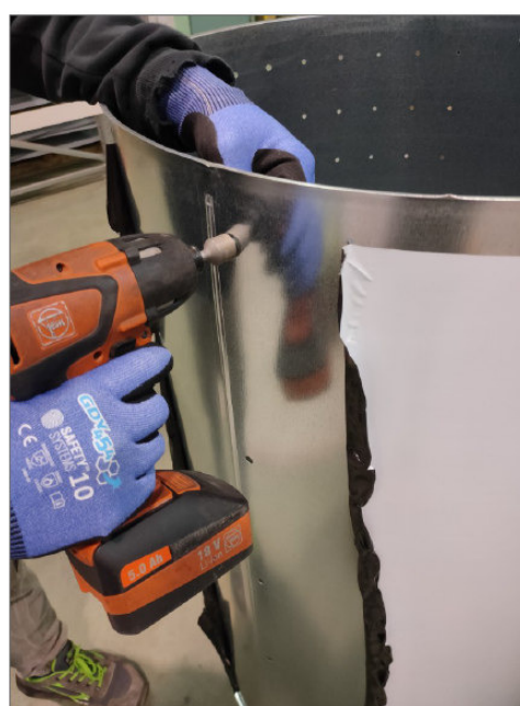
CHIUSURA CON AVVITATORE
