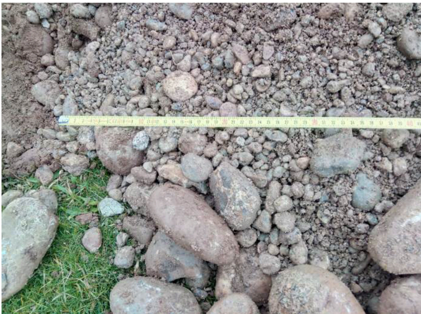
Scavo esplorativo 1: granulometria delle ghiaie sabbiose con ciottoli e blocchi campionate
