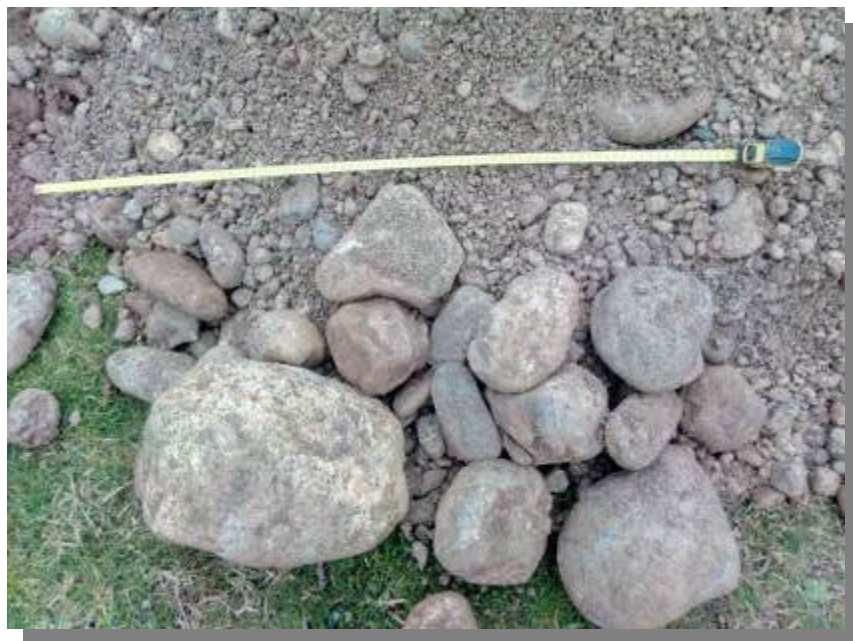
Granulometria dei depositi ghiaiosi soggiacenti le aree di progetto
