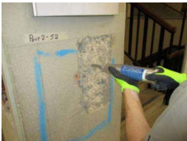
Prova sclerometrica e prova ultrasonica
