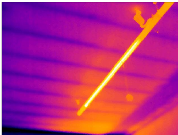
Foto n°5-6 - Individuazione della tramatura caratteristica dell'intradosso dell'Aula 1 al piano terra che conferma omogeneità dei plafoni su tutto il piano.
