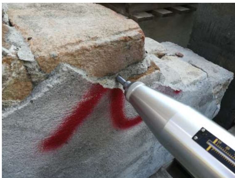
Strumentazione : Sclerometro "PASI" - mod. Tipo M - matr. M 0051
