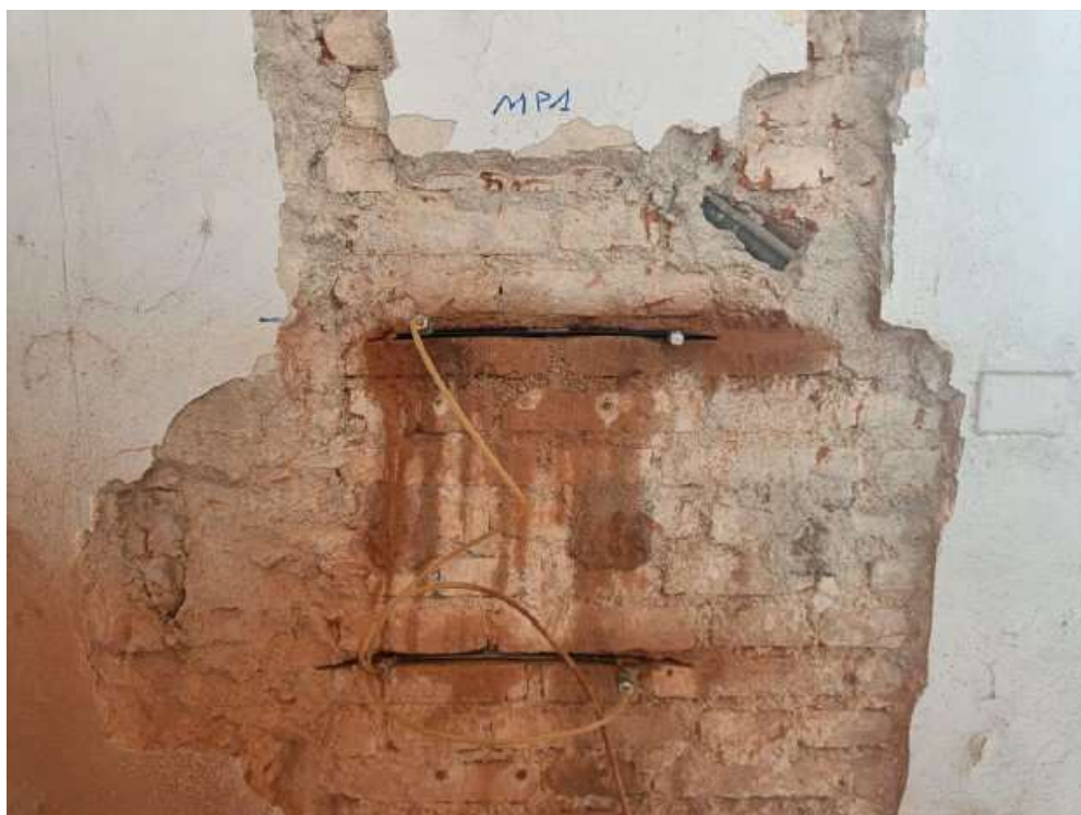
Figura 10: saggio 8 – M11- lato interno - muro perimetrale PT – prova martinetto piatto singolo e doppio
