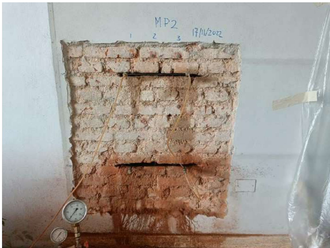
Figura 5: saggio 6 - M6 – muro perimetrale PT – prova martinetto piatto singolo e doppio
