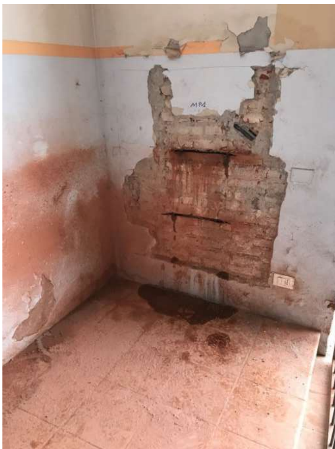
Figura 9: saggio 8 – M11 - muro perimetrale PT – prova martinetto piatto singolo e doppio
