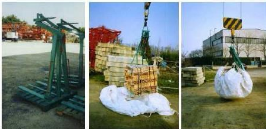
- sacco per imbraccio e sollevamento laterizi tramite forca – rete a maglie 50 x 50 con telo in polipropilene e 8 anelli perimetrali a chiusura del sacco – foto a produzione Tecnobrevetti
