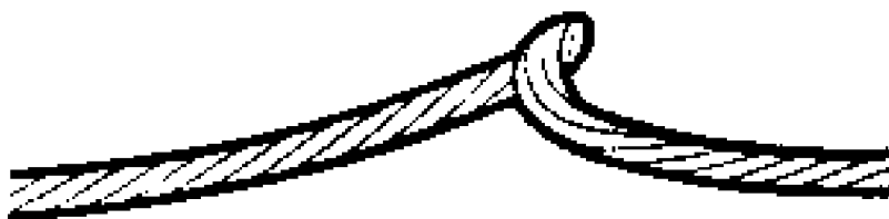
Fig.5.13.8 Evitare che si formino i cosiddetti "occhi schiacciati"
