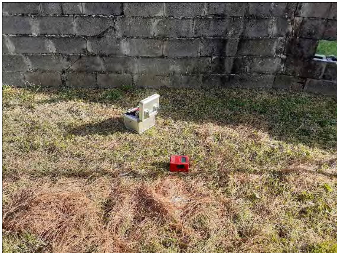
Fig. 7 - Esecuzione dell'indagine sismica con stazione singola HVSR_1 (12/04/2022)
