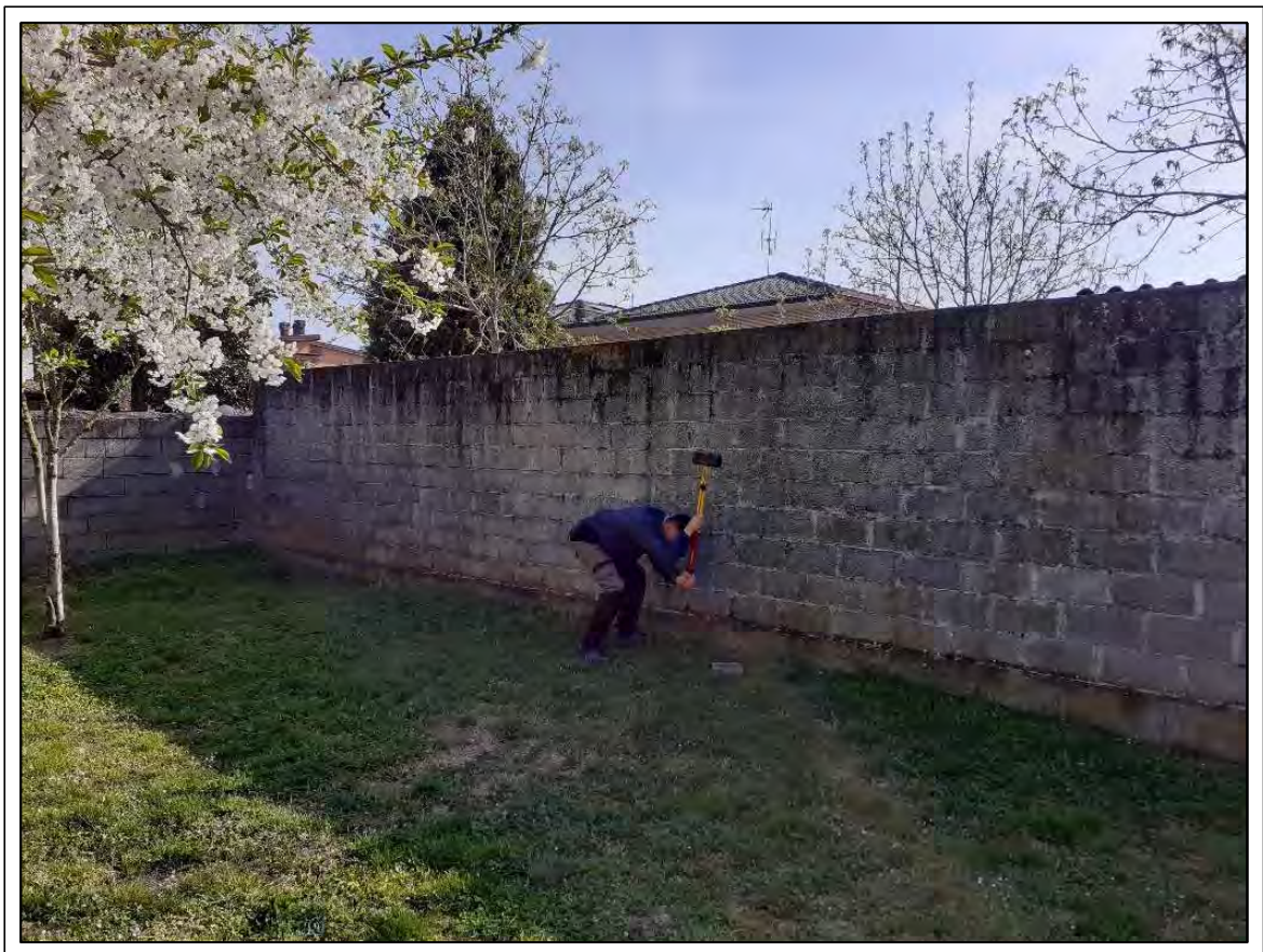
Fig. 6 - Esecuzione della prova MASW (12/04/2022)
