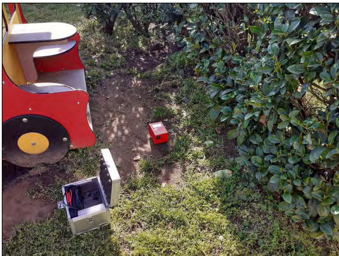
Fig. 8 - Esecuzione dell'indagine sismica con stazione singola HVSR_2 (12/04/2022)
