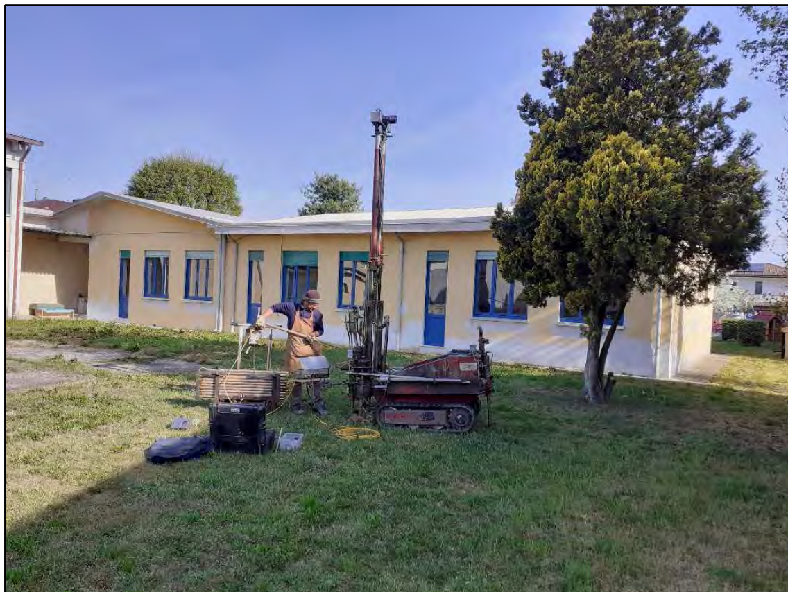
Fig. 1 - Esecuzione della prova penetrometrica statica elettrica CPTu-01 (12/04/2022)
