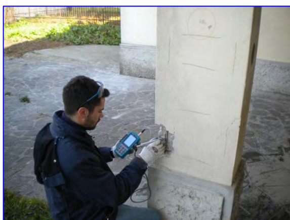
Indagine Vickers effettuata su pilastro
