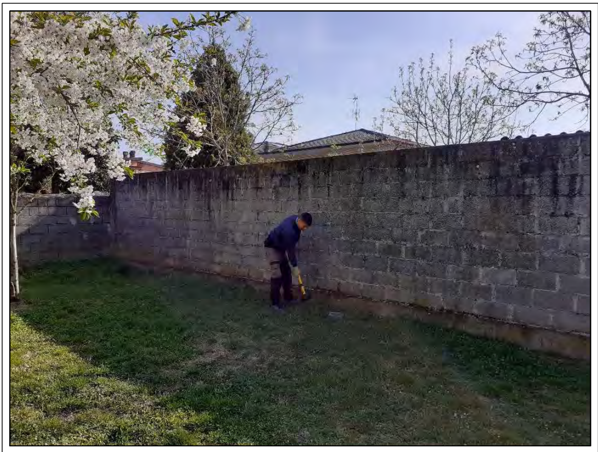
Fig. 5 - Esecuzione della prova MASW (12/04/2022)
