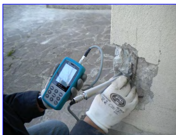
Indagine Vickers effettuata su pilastro
