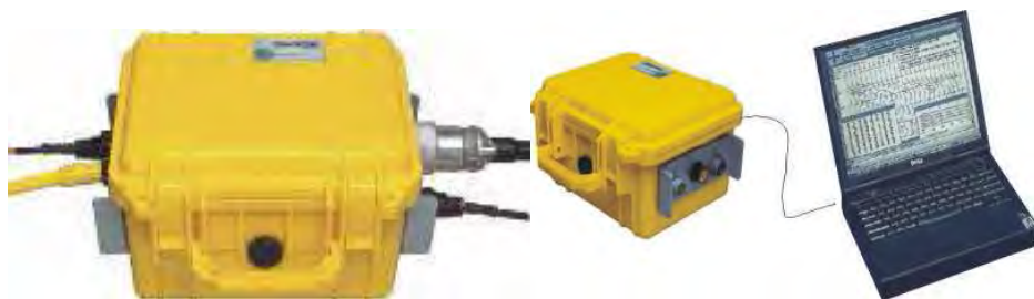
Figura 1: Sismografo "Geode" collegato al pc
