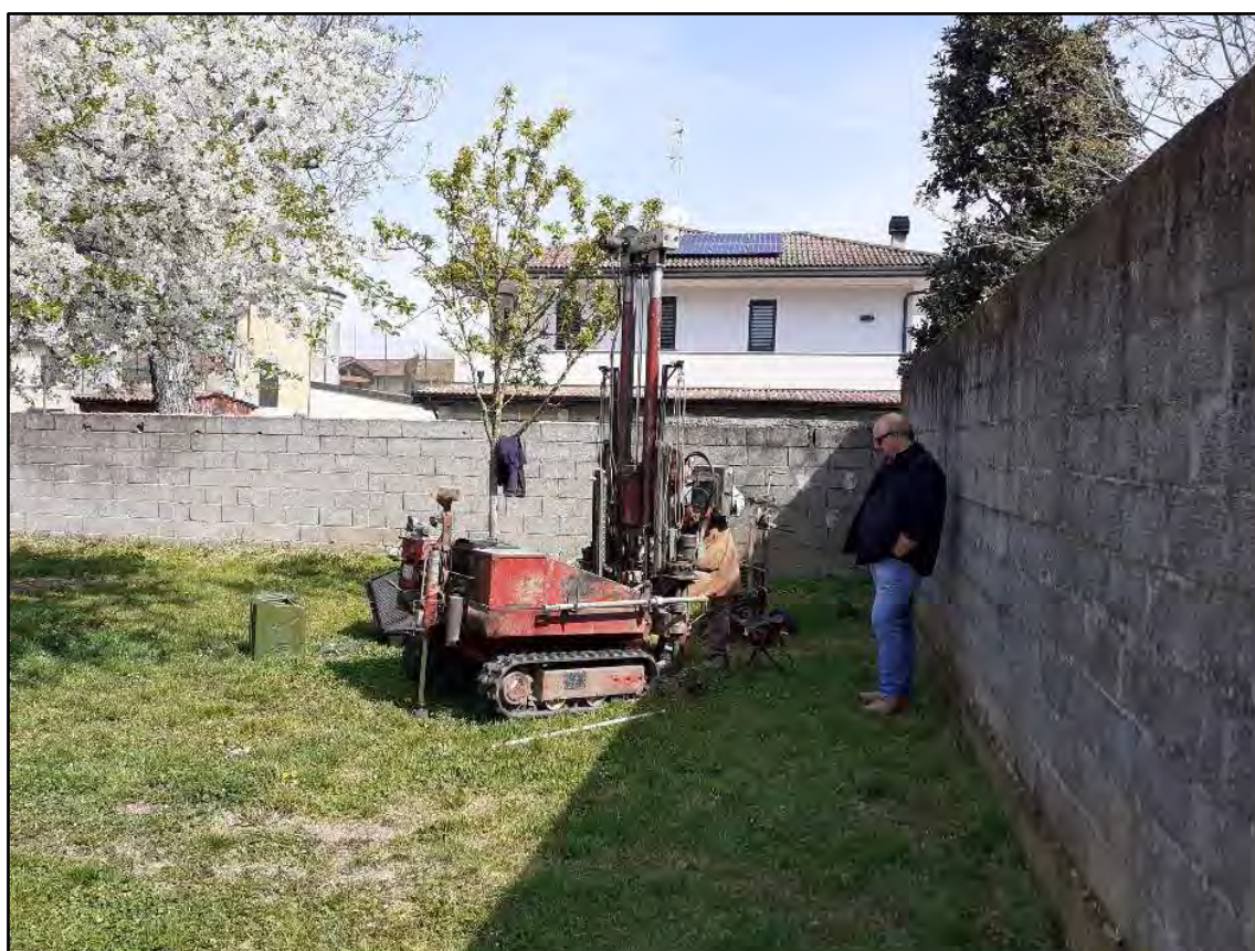
Fig. 2 - Esecuzione della prova penetrometrica statica elettrica CPTu-02 (12/04/2022)
