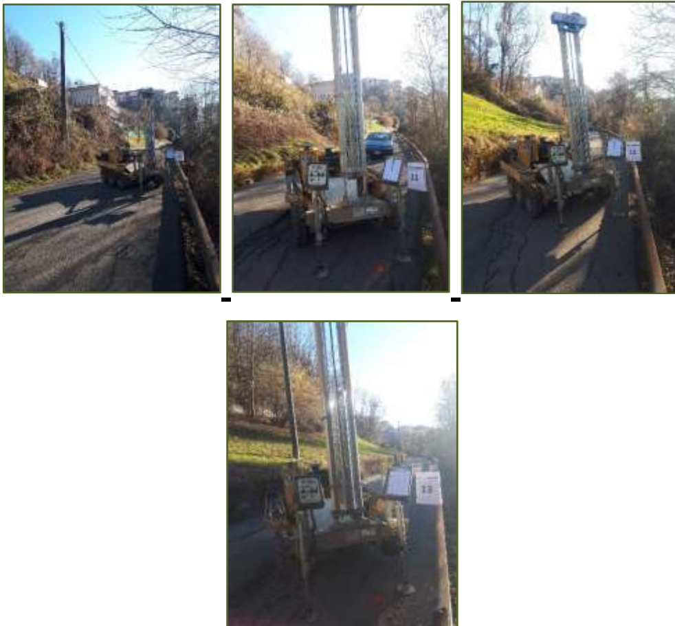
Figure 16 – Esecuzione delle penetrometrie
