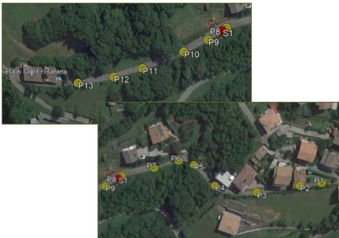
Figura 11 – Ubicazione delle indagini geognostiche in relazione all'opera di progetto (S1: sondaggio; P1-P13: prove penetrometriche dinamiche)
