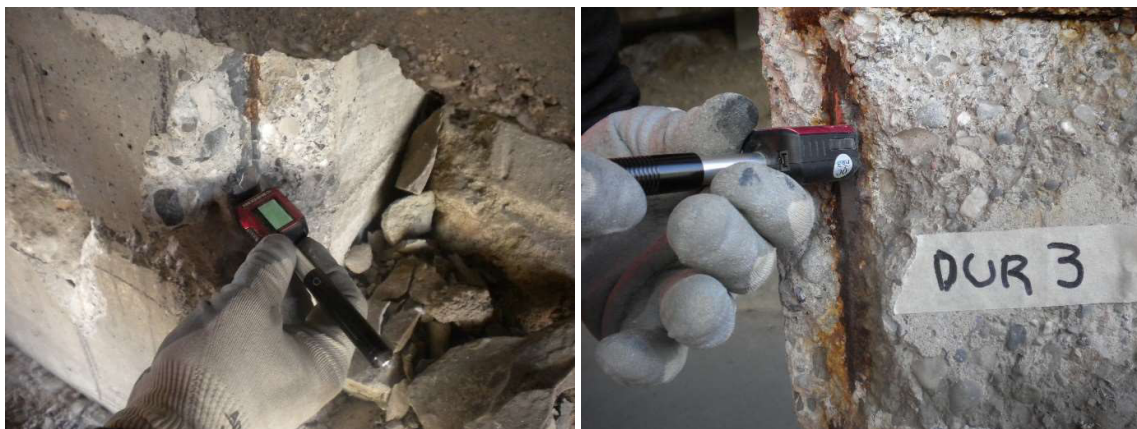
Prove con durometro su barre d'armatura
