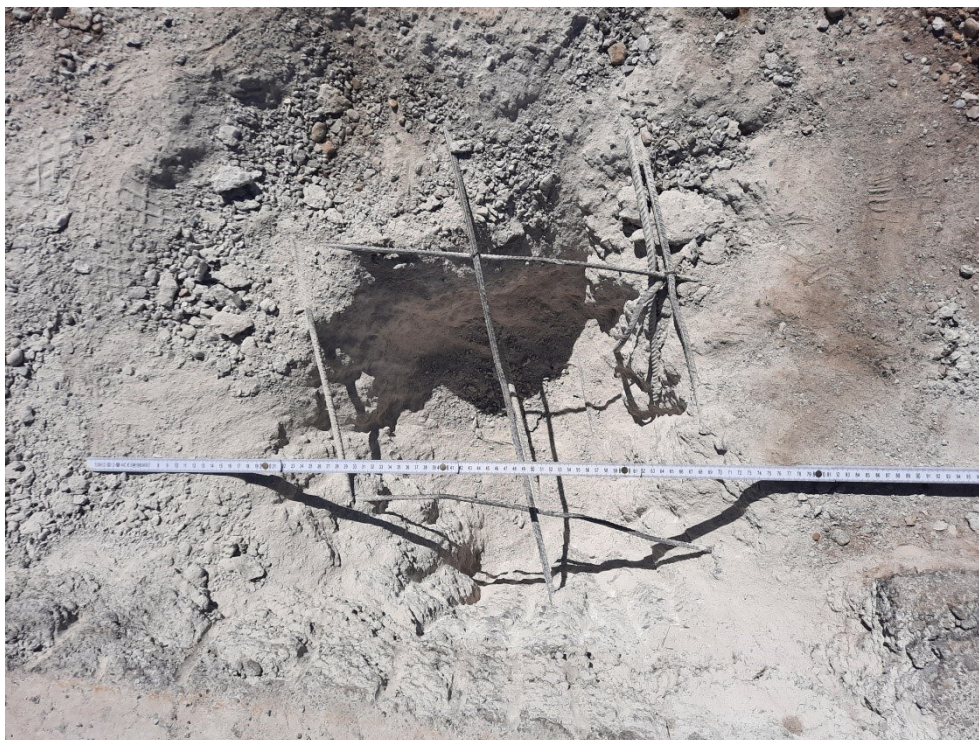
Foto 27 – Sondaggio sulla soletta
