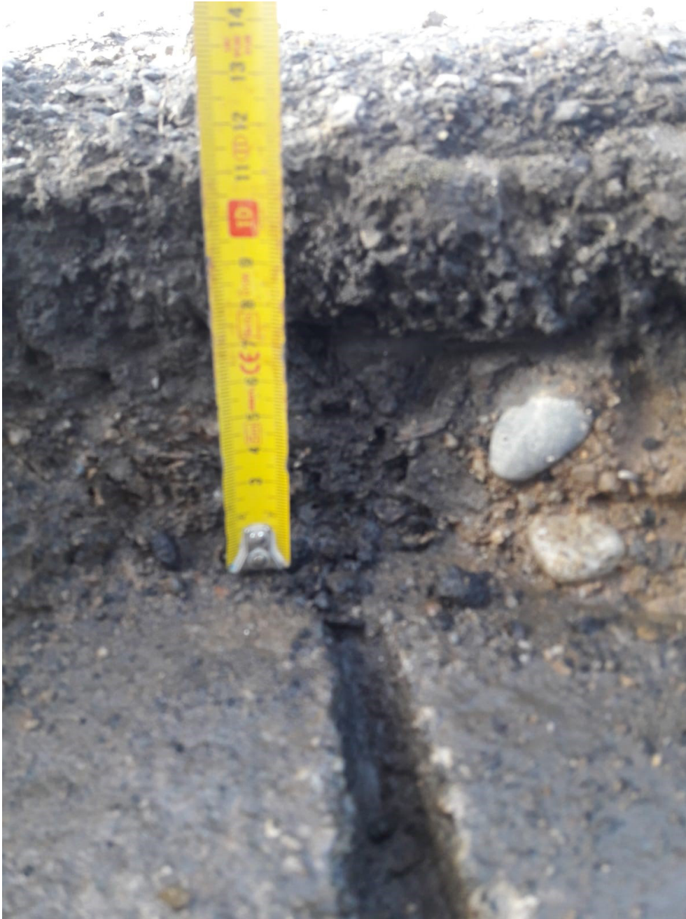
Foto 25 - Stratigrafia pavimentazione stradale
