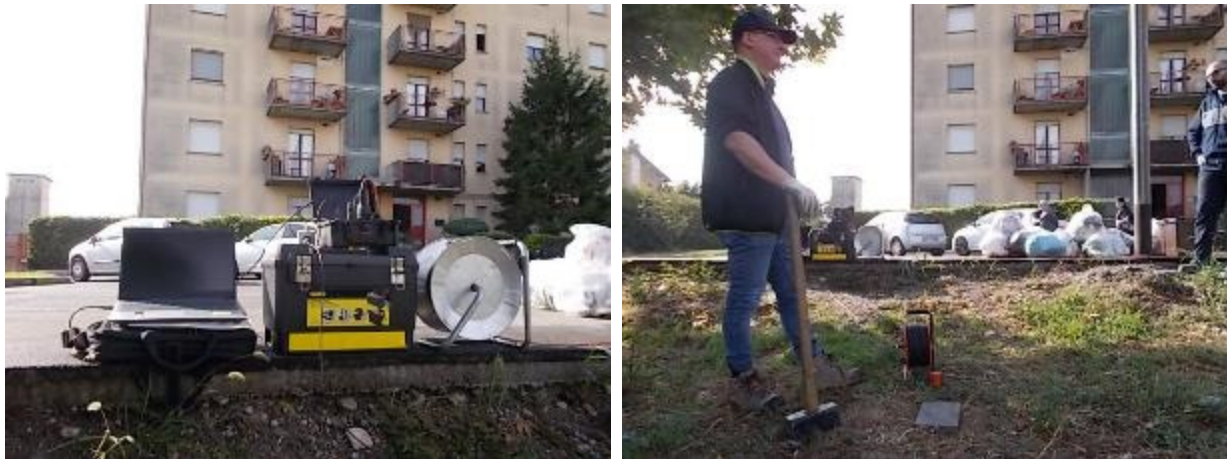
Sismografo e punto di energizzazione
