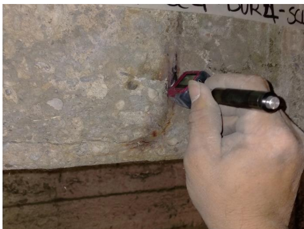
Prove con durometro su barre d'armatura
