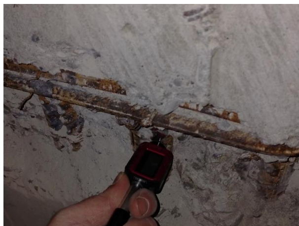
Prove con durometro su barre d'armatura
