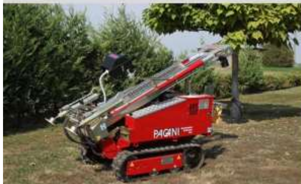
Figura 21 – Penetrometrica dinamico superpesante e statico da 20 ton
