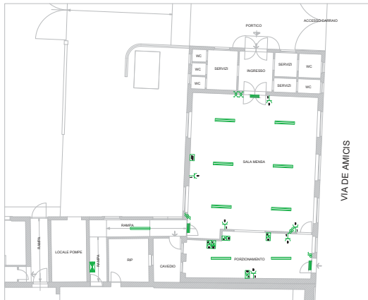
STATO DI FATTO IMPIANTO ELETTRICO PLANIMETRIA Scala 1:100
