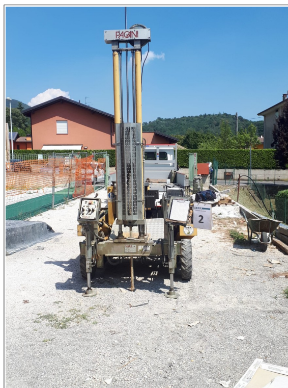
Esecuzione delle prove penetrometriche dinamiche.
