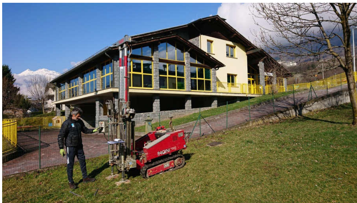
Indagine penetrometrica DPSH
