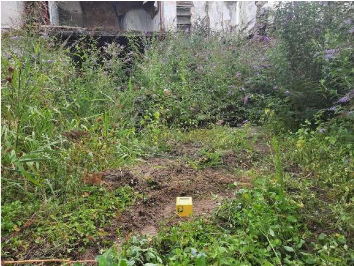
Figura 6: esecuzione di registrazione di sismica passiva presso l’area oggetto di intervento
