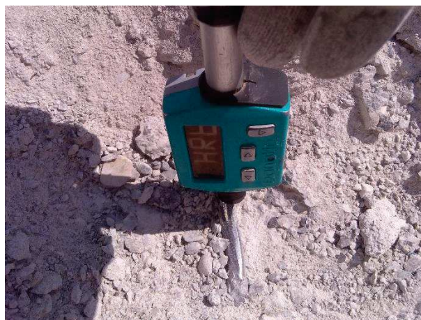
Prove con durometro su barre d'armatura
