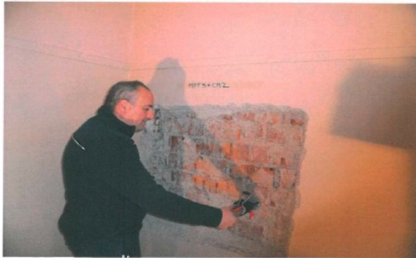
Figura 6 - Indagini sulla muratura (fonte: relazione di Vulnerabilità sismica – ing. F. Massardi)
