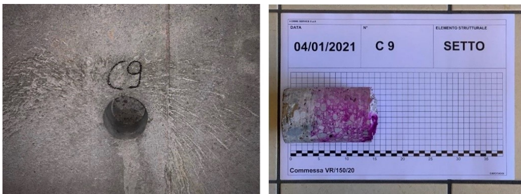
Figura 16 – Carotaggio C9 effettuato sul muro di cantinato (fonte: relazione sulle Indagini diagnostiche Prova n°5725/VR – 4 EMME Service S.p.A.)
