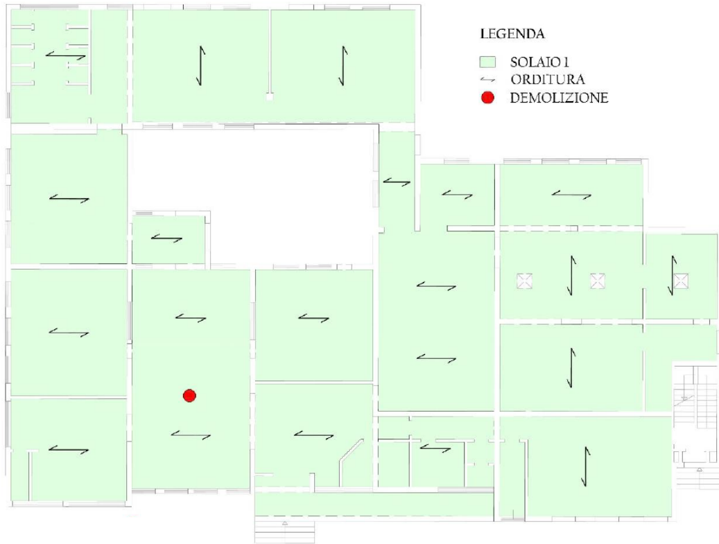
Figura 24 - Planimetria dell'impalcato di copertura del piano terra con indicazione del punto di esecuzione delle indagini (fonte: relazione di Conformità Statica delle Strutture Orizzontali – Tecnoindagini srl).
