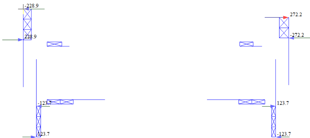
Figura 209 – Reazioni di equilibrio offerte dalla presenza delle lesene ortogonali per sisma in direzione Y.
