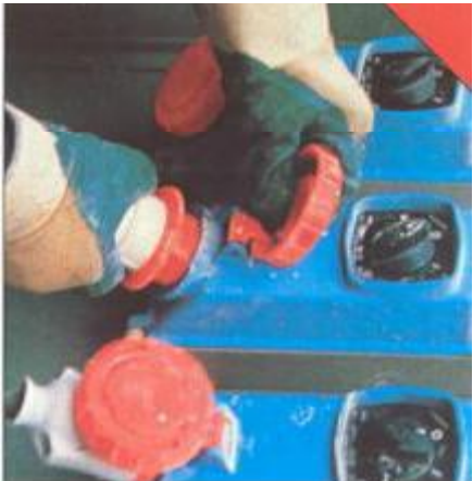
Modo corretto di staccare una spina mobile da una presa fissa
