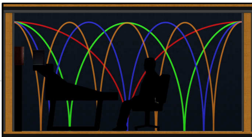
Schema con rappresentazione di onde stazionarie tra pareti parallele non fonoassorbenti
