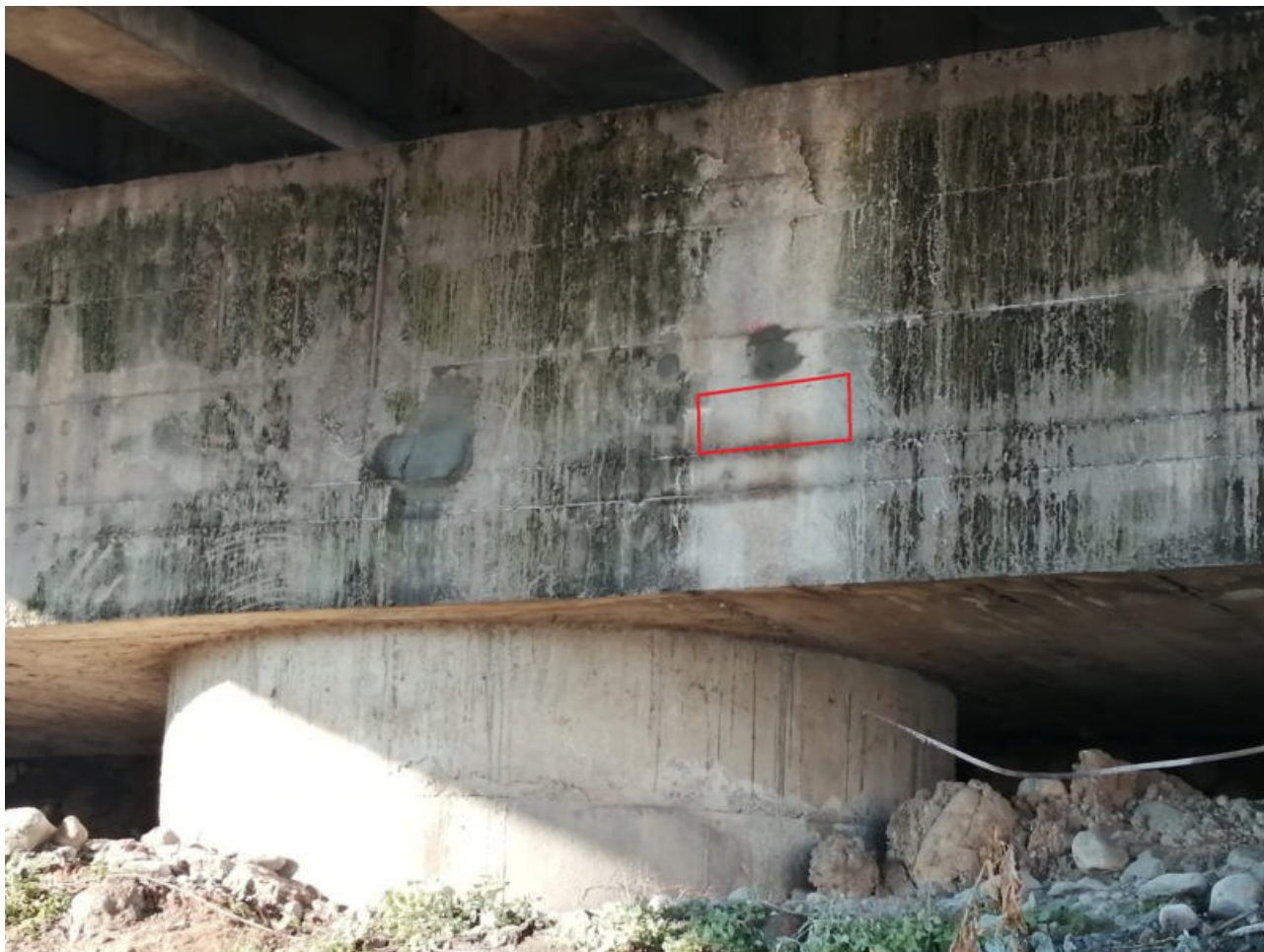
Fig.14: ubicazione battute sclerometriche su spalla A.
