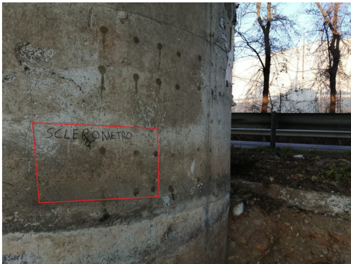
Fig.7: ubicazione battute sclerometriche su fusto pila B.
