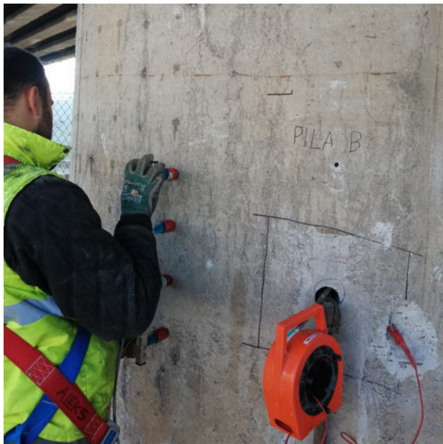
Fig.34: esecuzione della misura del potenziale di corrosione sulla pila B.
