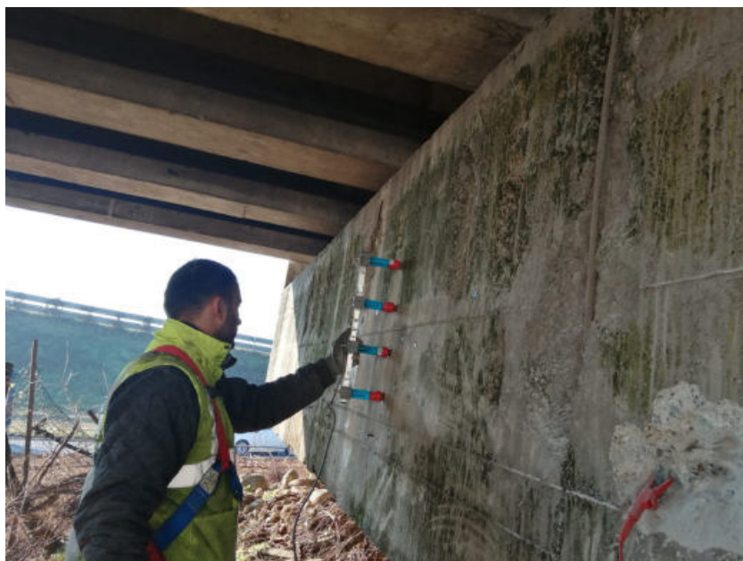
Fig.31: esecuzione della rilevazione del potenziale di corrosione sulla spalla A.
