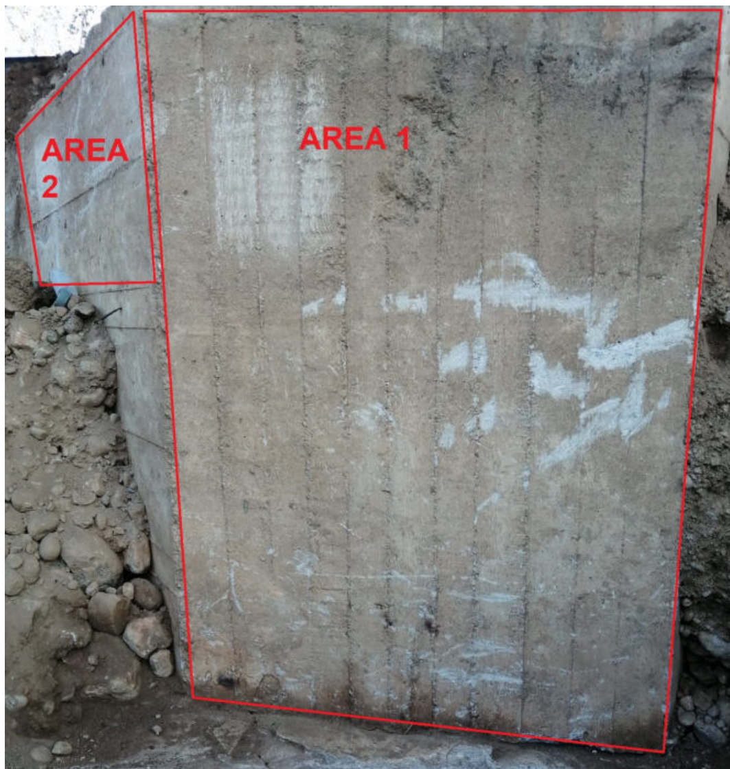
Fig.19: aree interessate dalla pacometria sul plinto pila C.
