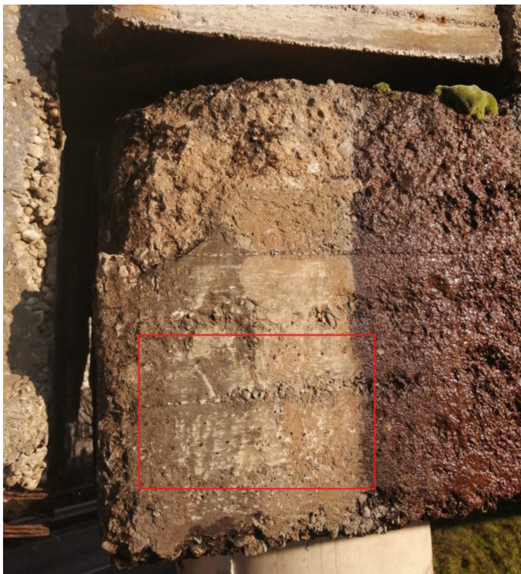
Fig.8: ubicazione battute sclerometriche su mensolina 1 sella Gerber pila C.
