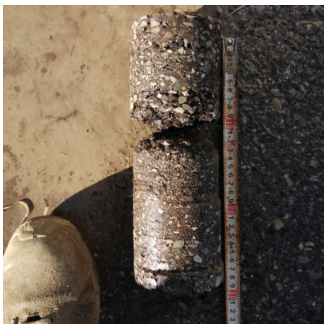
Fig.5: carota C1 pila C estratta e misurata.
