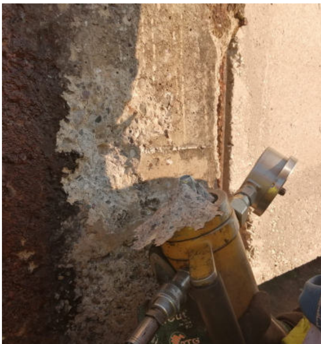
Fig.30: estrazione del cono di calcestruzzo al termine della prova di estrazione.
