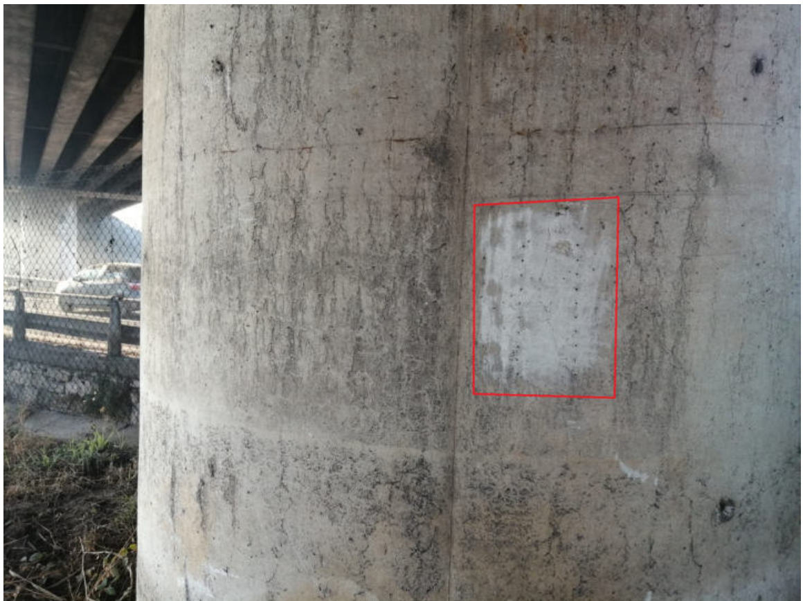
Fig.6: ubicazione battute sclerometriche su fusto pila B.
