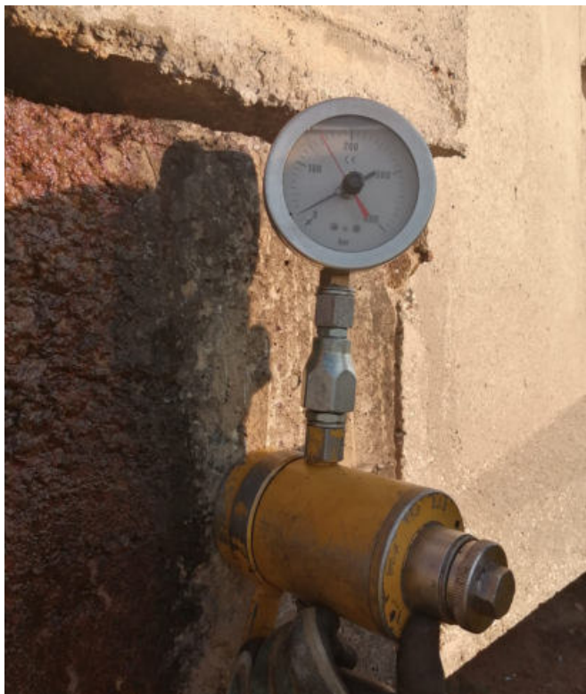
Fig.29: raggiungimento della pressione di rottura per la prova di estrazione sulla mensolina 2 sella Gerber pila C.
