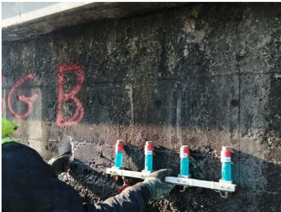
Fig.35: esecuzione della misura del potenziale di corrosione sulla sella Gerber della pila B.
