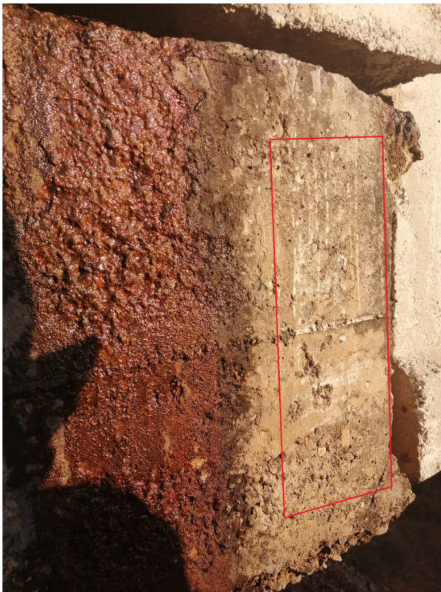
Fig.9: ubicazione battute sclerometriche su mensolina 2 sella Gerber pila C.
