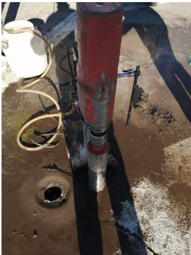
Fig.4: esecuzione carota C2 pila B.
