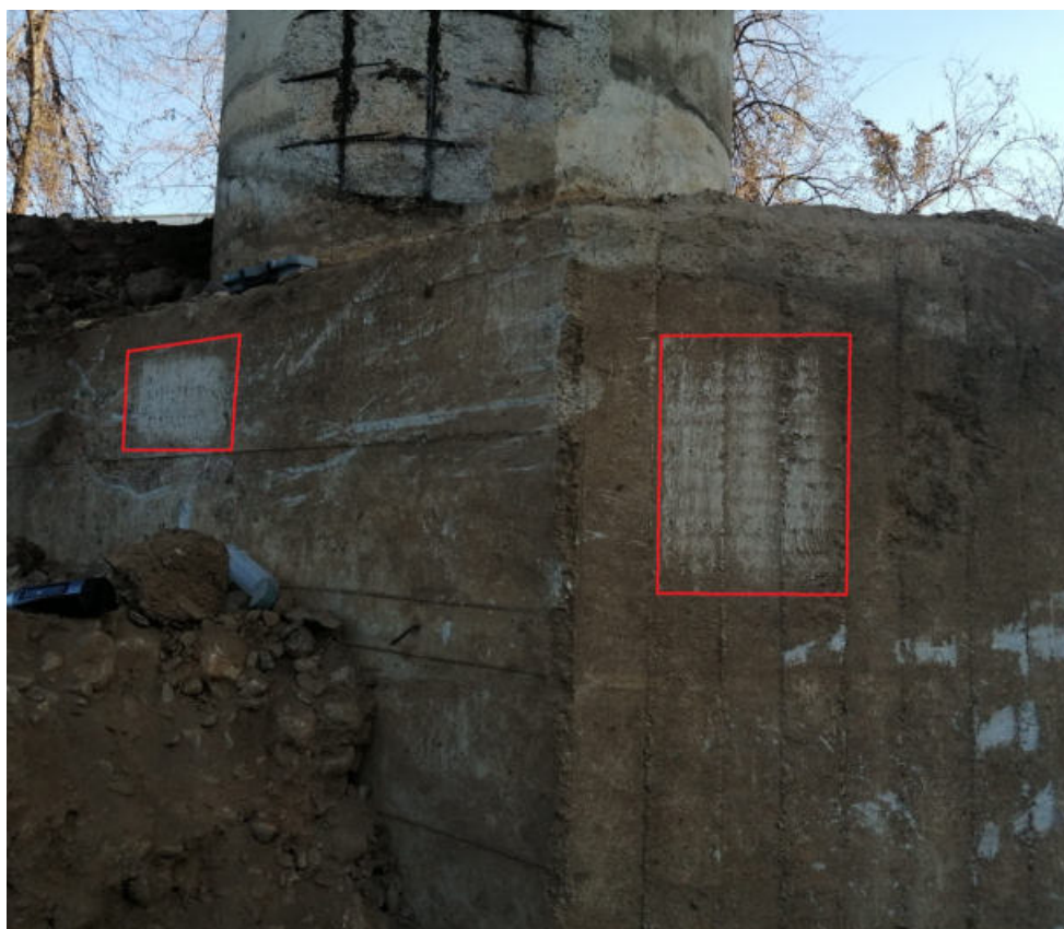
Fig.5: ubicazione battute sclerometriche su plinto pila C.
