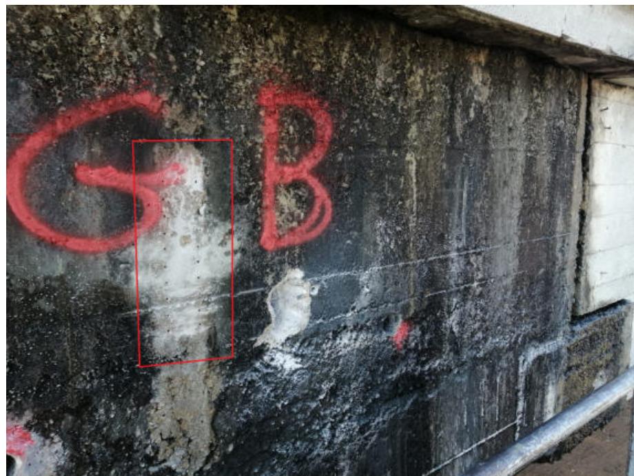
Fig.12: ubicazione battute sclerometriche su anima sella Gerber pila B.
