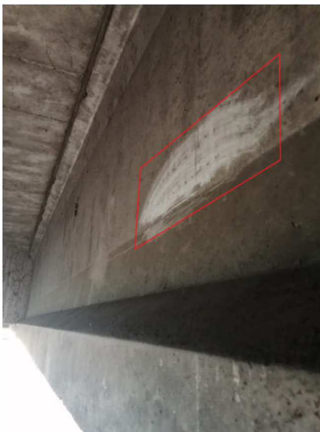
Fig.13: ubicazione battute sclerometriche su anima trave 4 campata BC.
