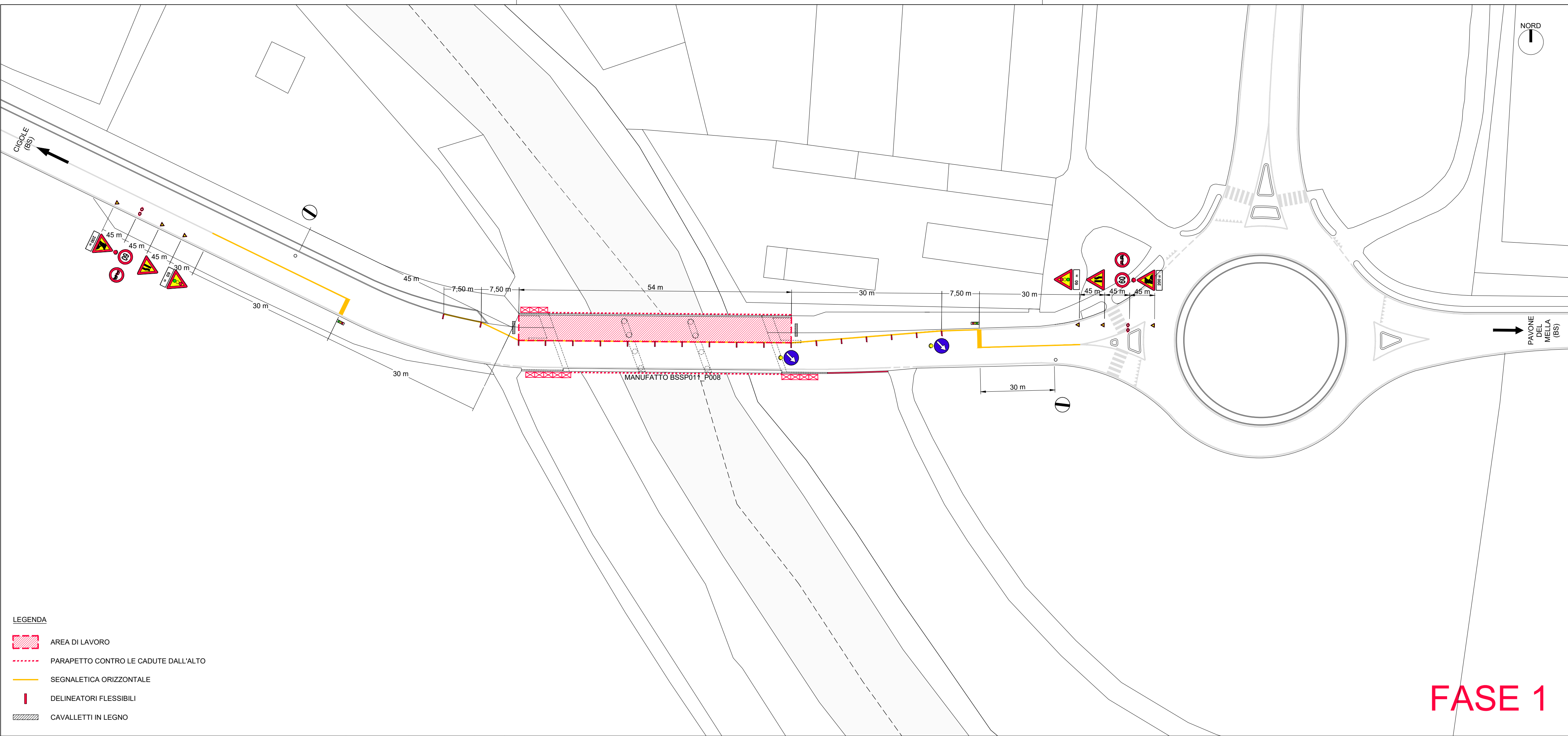
PLANIMETRIA CANTIERE - FASE 1 - PIANO FLUVIALE SCALA 1:500
