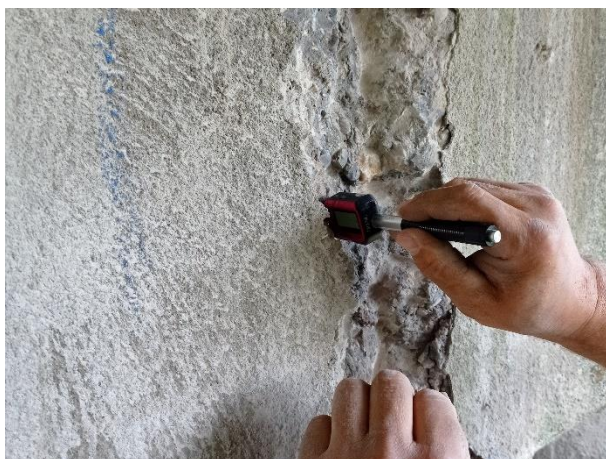
Prove con durometro su barre d'armatura
