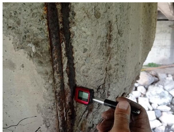
Prove con durometro su barre d'armatura
