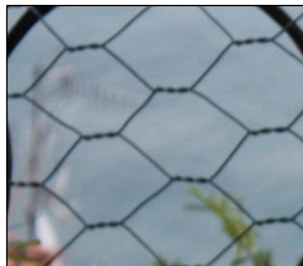
Rete secondaria: rete a singolo filo a maglia esagonale (doppia torsione)
