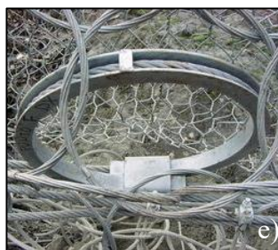
ARTIGIANA COST: Freno a deformazione materiale + attrito (*)
