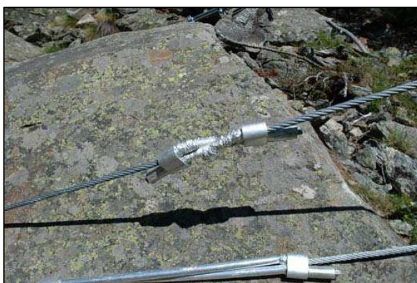
Figura 71: Esempio di un freno Maccaferri post-impatto (Peila, 2017).
