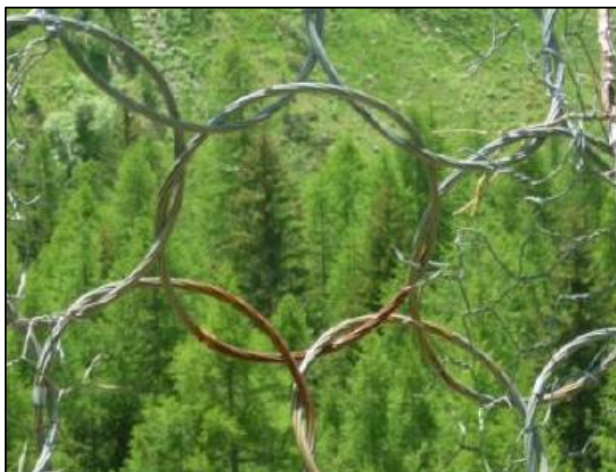
Figura 69: Esempio di corrosione localizzata di una rete principale ad anelli metallici a causa di un impatto (Luciani, 2015)
