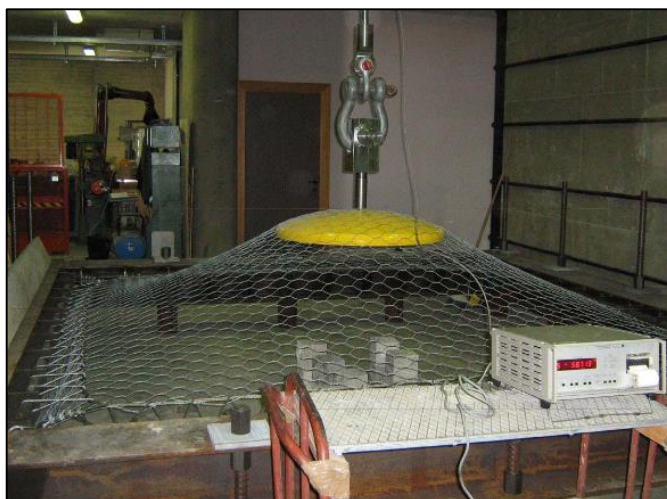
Figura 48: Prove di punzonamento per i rivestimenti corticali con schema qualitativo e rappresentazione reale (Cardinali, 2016).
