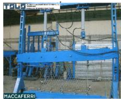
Figura 47: Prove di trazione per i rivestimenti corticali con schema qualitativo e rappresentazione reale (Cardinali, 2016).
