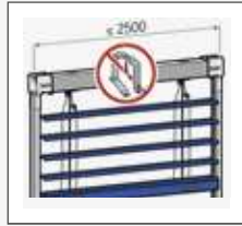
La struttura autoportante della tenda
