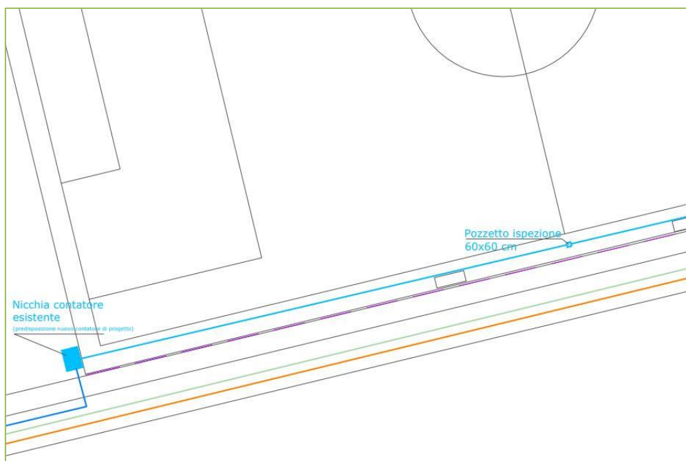
Figura 20 – Estratto Tav.A.06 Reti tecnologiche – Posizionamento del nuovo contatore per allaccio alla rete idrica esistente
