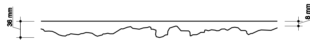
PARTICOLARE TIPO SEZIONE MATRICE CON DIMENSIONI MASSIME INDICATE SCALA 1:10
