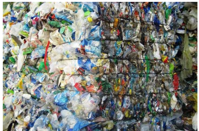
Figura 35 - Imballaggi in plastica prima e dopo la lavorazione: cernita e compattazione favoriscono le lavorazioni successive
