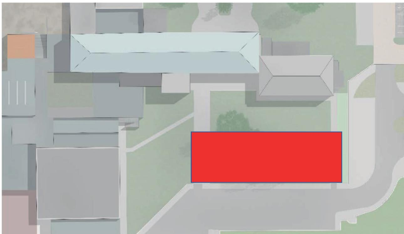
La superficie coperta dell'edificio progettato, ovvero l'ingombro fisico a terra, risulta pari a 720 mq mentre il suo volume complessivo è di circa 5250 metri cubi.
