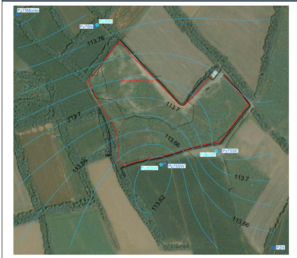
Figura 2.1 – Elaborazione piezometrica (monitoraggio ottobre 2016)
