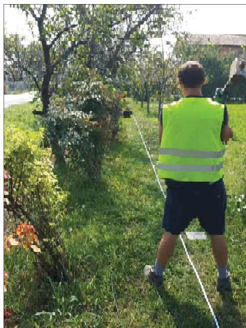
Shot sismico per la generazione delle onde di Rayleigh
