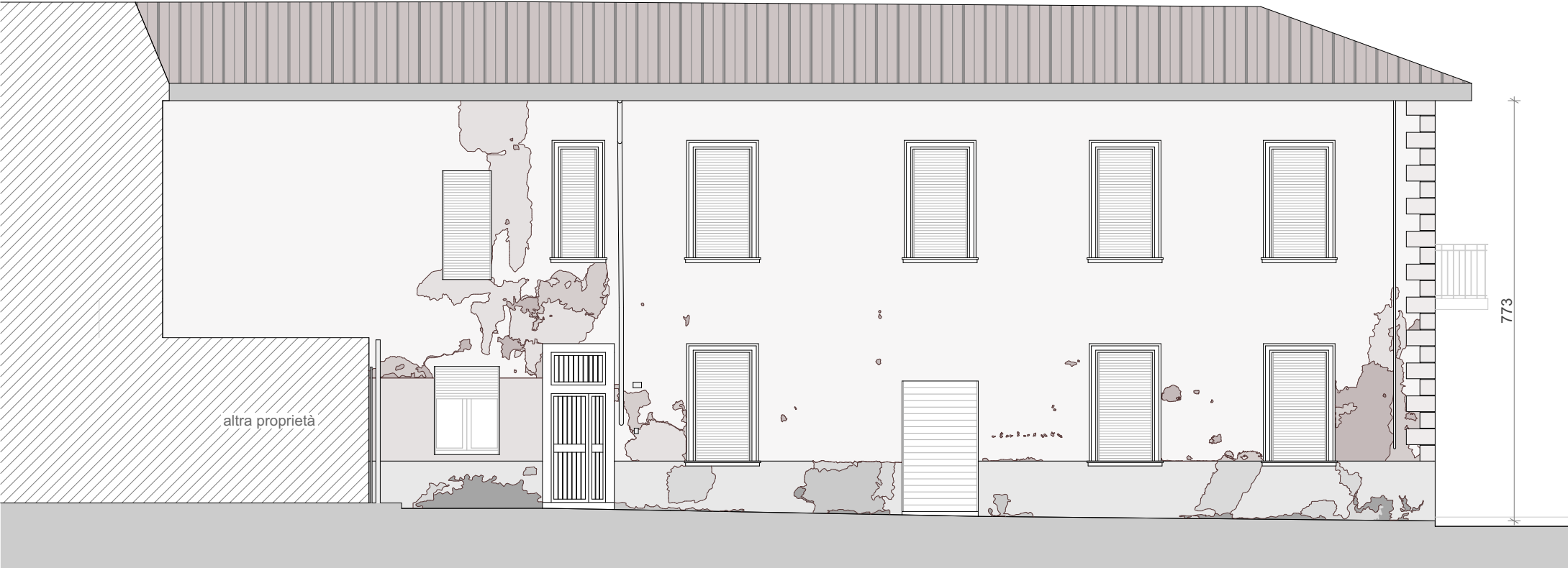
Prospetto Nord Est Degrado 1:100
