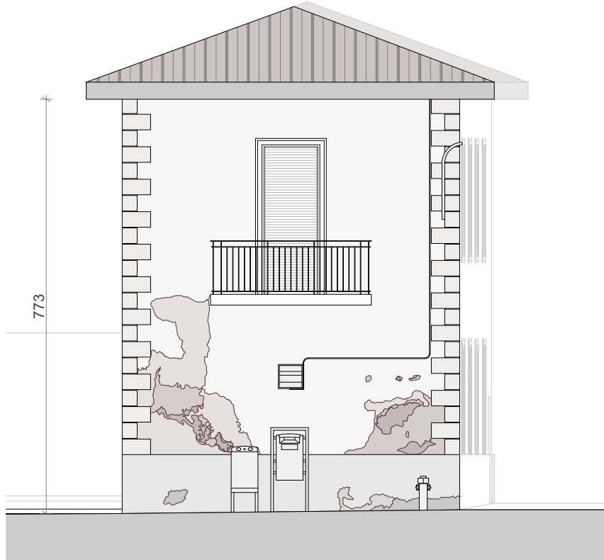
Prospetto Nord Ovest Degrado 1:100
