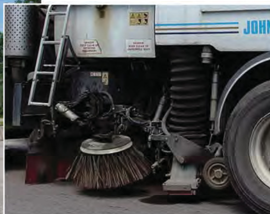
Spazzatura e raccolta del fresato residuo tramite macchina spazzatrice e particolare delle piastre rotanti e del sistema di aspirazione.
