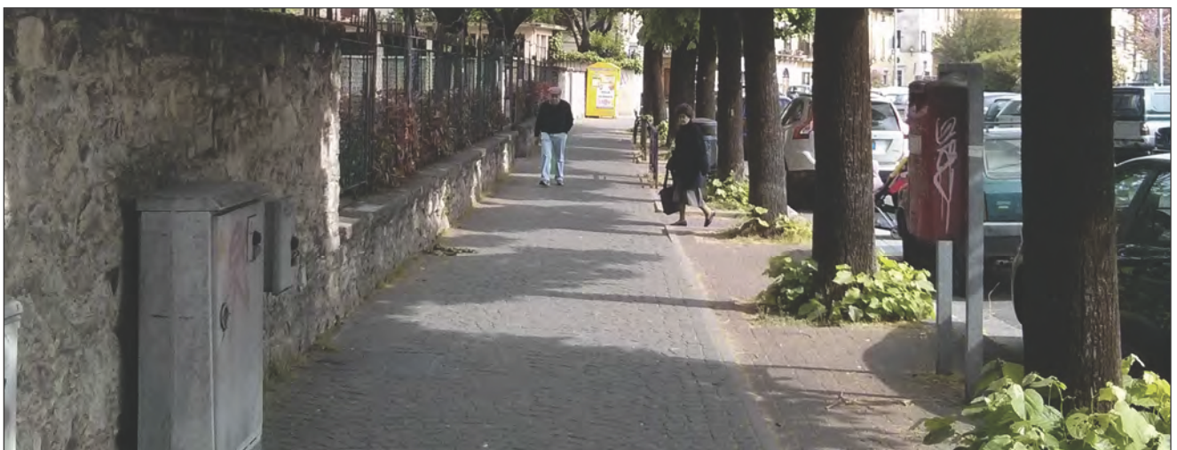
Figura 7 - Differenziazione materica tra piano di circolazione pedonale e fascia di filtro, in cui è presente la vegetazione arborea.
