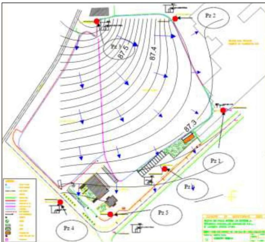
**Figura 7** – Ricostruzione piezometrica discarica MONTI.RI.AM. Marzo 2015 (Fonte: Rapporto di prelievo acque sotterranee c/o discarica di Montichiari – Loc. Fascia d'Oro, Marzo 2015)
