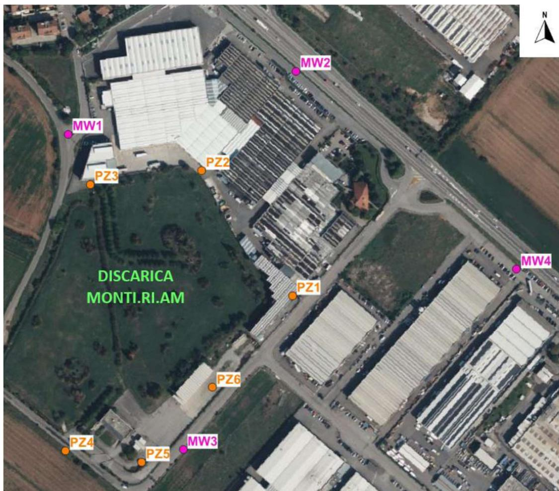
**Figura 3** – Ubicazione piezometri realizzati e punti di monitoraggio Area MONTI.RI.AM.
