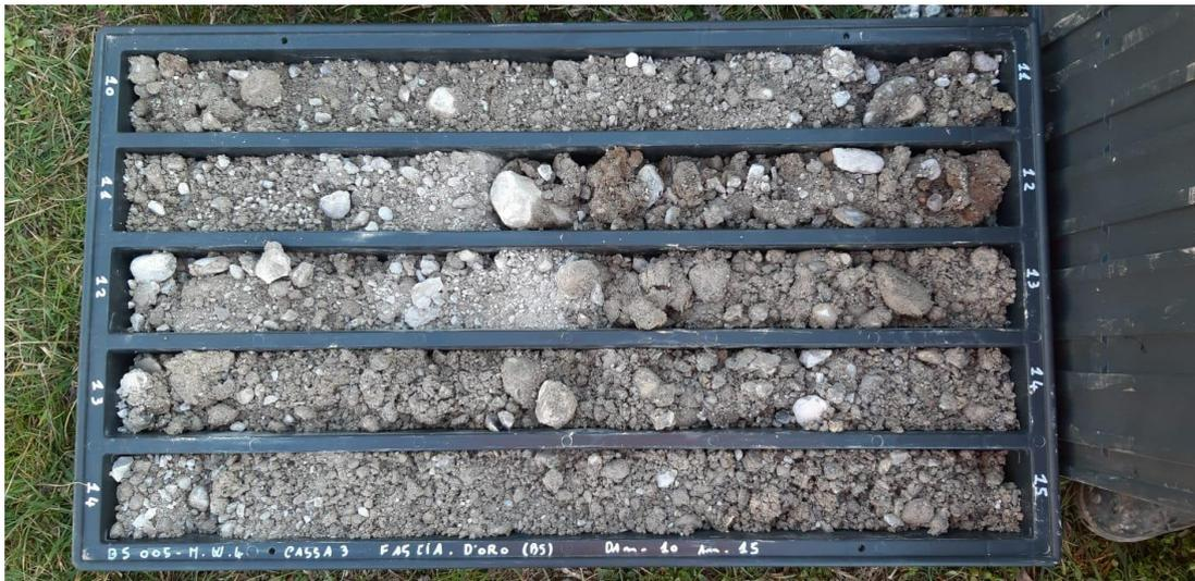
**SONDAGGIO MW4: Cassa n.3 da 10.00 a 15.00 m**
