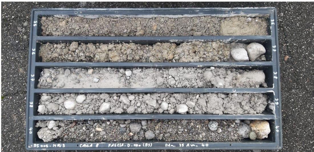
**SONDAGGIO MW3: Cassa n.8 da 35.00 a 40.00 m**
