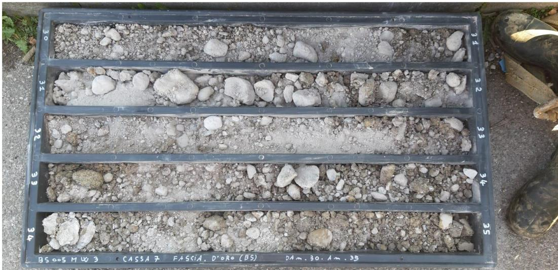
**SONDAGGIO MW3: Cassa n.7 da 30.00 a 35.00 m**
