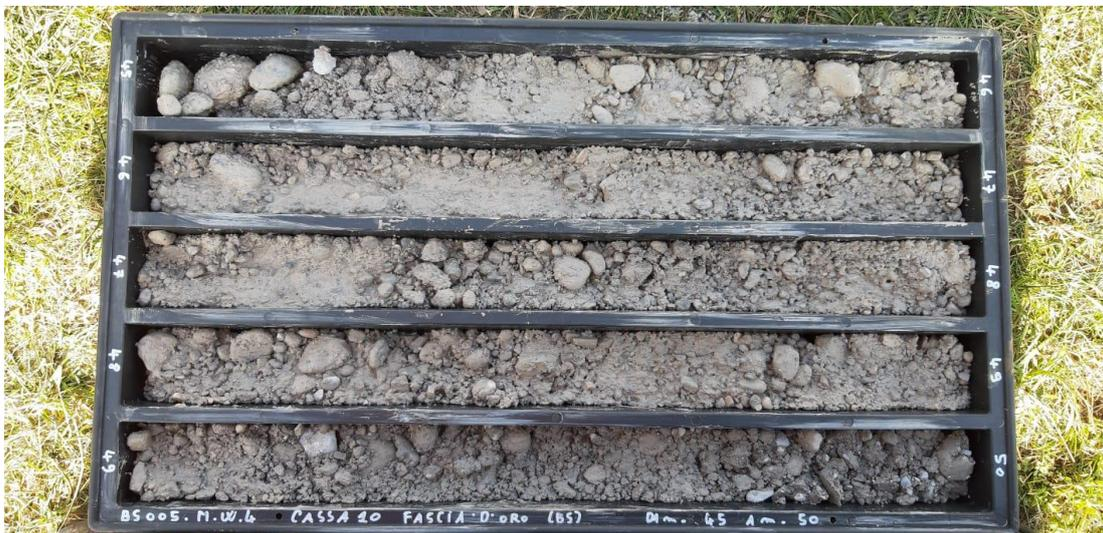
**SONDAGGIO MW4: Cassa n.10 da 45.00 a 50.00 m**
