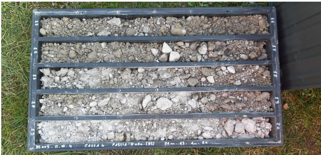
**SONDAGGIO MW4: Cassa n.4 da 15.00 a 20.00 m**
