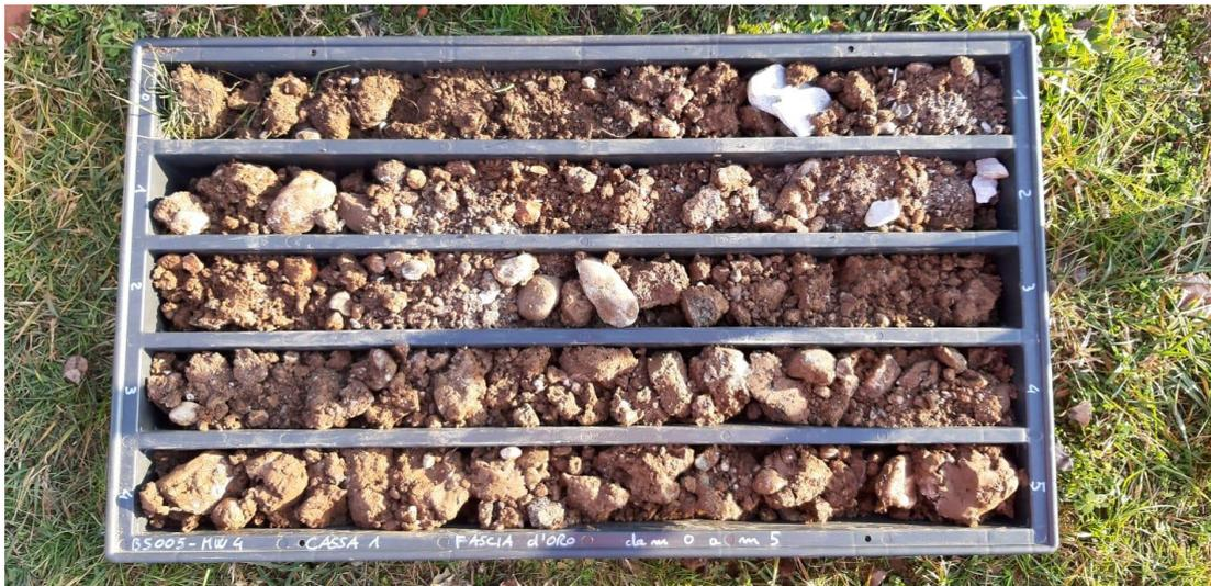
**SONDAGGIO MW4: Cassa n.1 da 0.00 a 5.00 m**
