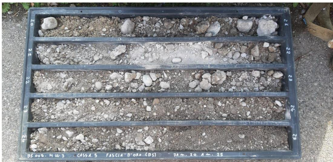
**SONDAGGIO MW3: Cassa n.5 da 20.00 a 25.00 m**
