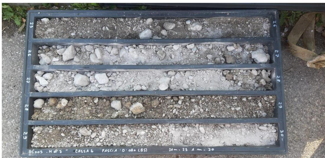
**SONDAGGIO MW3: Cassa n.6 da 25.00 a 30.00 m**
