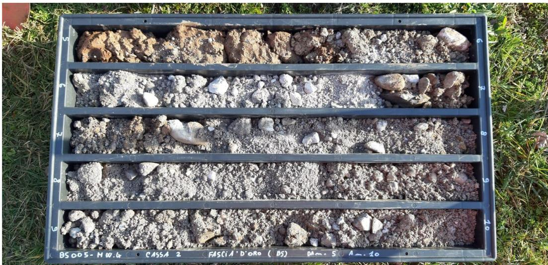
**SONDAGGIO MW4: Cassa n.2 da 5.00 a 10.00 m**
