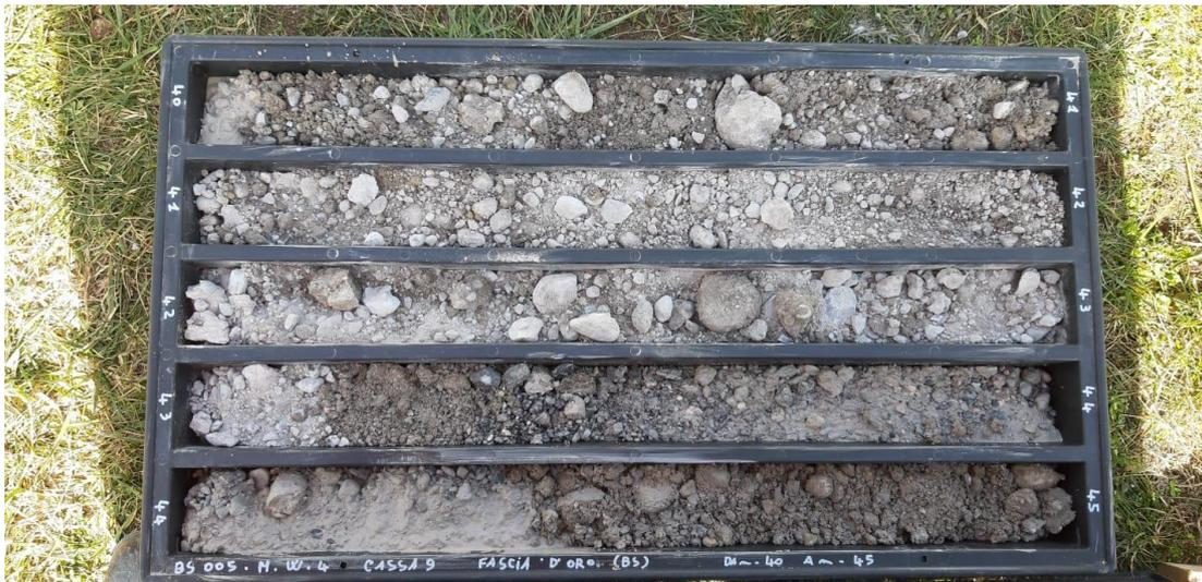
**SONDAGGIO MW4: Cassa n.9 da 40.00 a 45.00 m**
