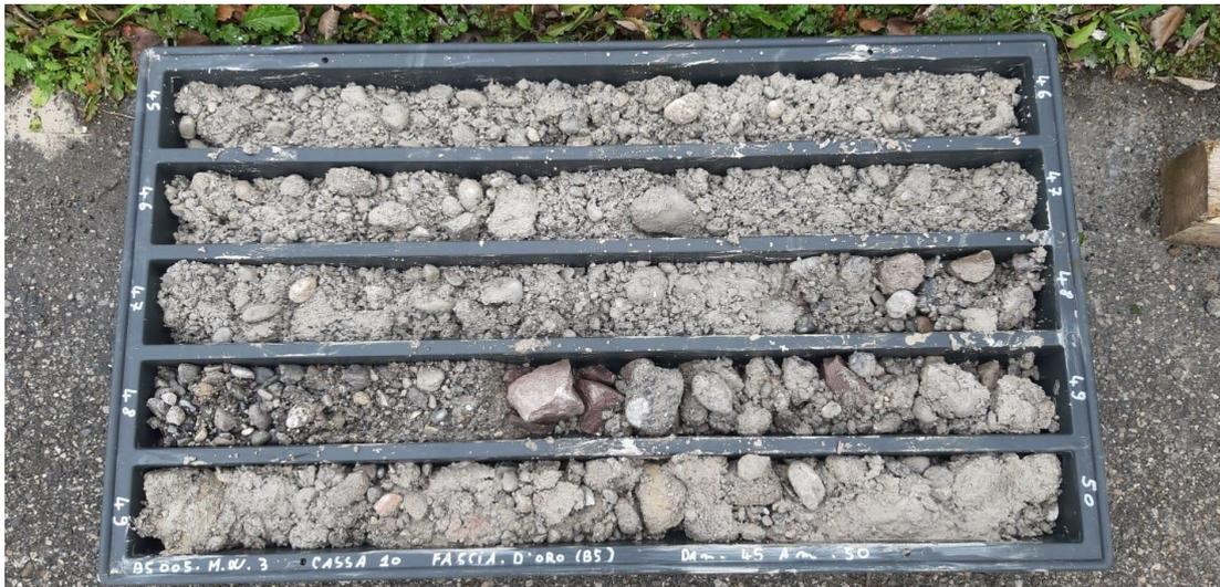
**SONDAGGIO MW3: Cassa n.10 da 45.00 a 50.00 m**
