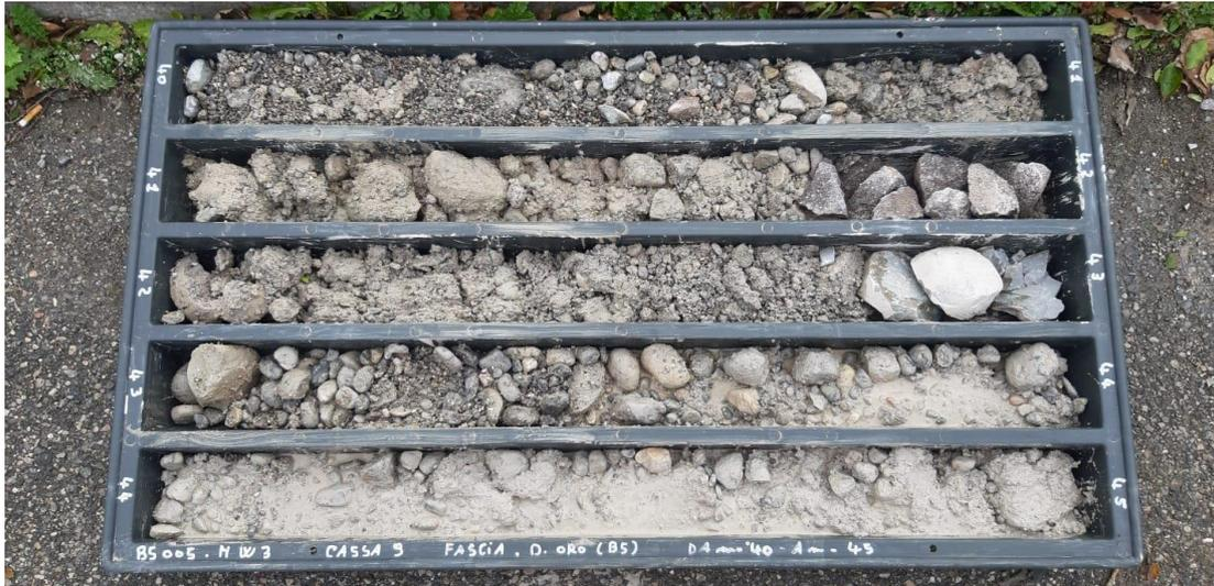
**SONDAGGIO MW3: Cassa n.9 da 40.00 a 45.00 m**
