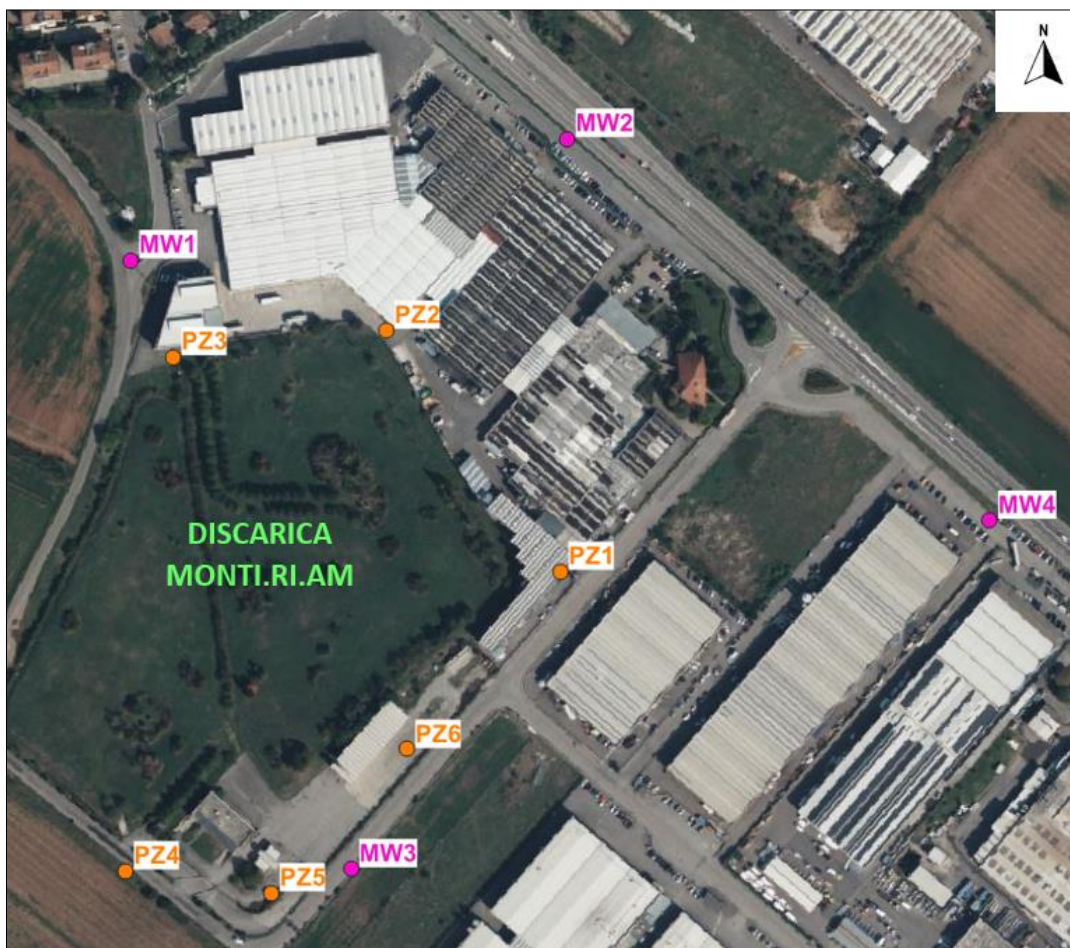
Figura 19: posizione dei piezometri monitorati nella Fase 1 (in arancione) e nella Fase 2 (in rosa) del progetto PLUMES
